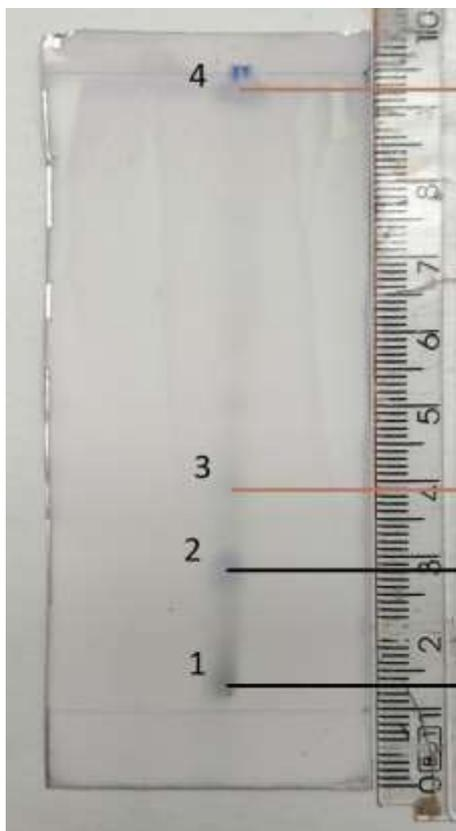
**Figura 19: Amostra de OE de noz-moscada em placa de sílica**
