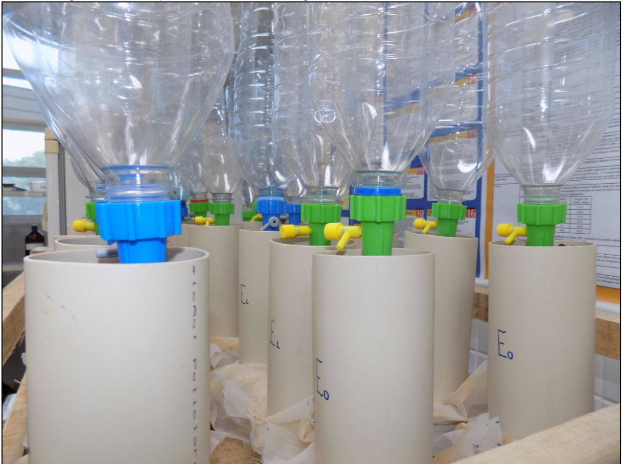
Figura 7 - Destaque do reservatório de água destilada, leito fixo e tecido consumido
