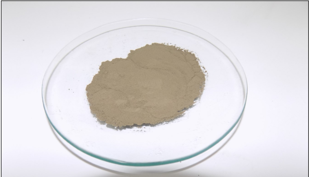
Figura 4 - Amostra do remineralizador de basalto pronto para uso após tratamento térmico e físico.
