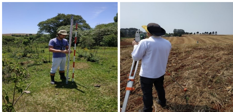
Figura 11 - Coleta de dados a campo de declividade e comprimento de rampa das glebas estudadas
