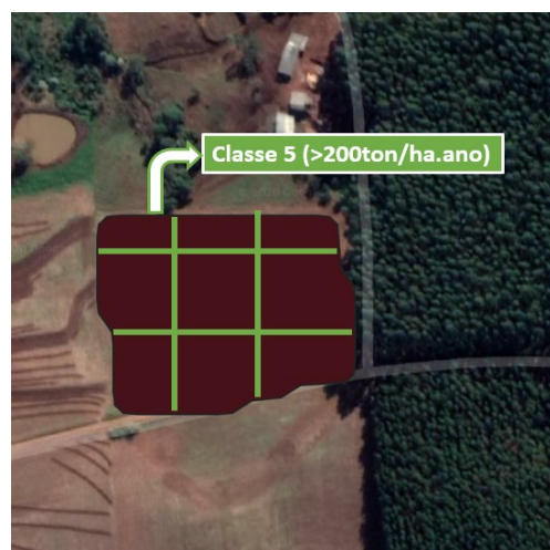
Figura 15 - Modelo "jogo da velha" utilizado nas medições a campo para a gleba 4
