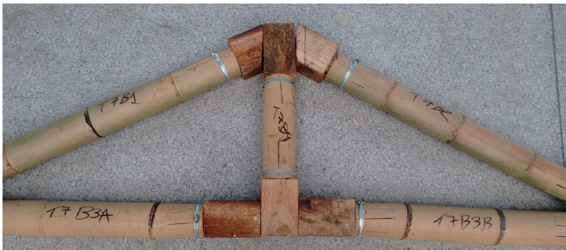
Figura 38 - Pinos de madeira com cola e braçadeira metálica
