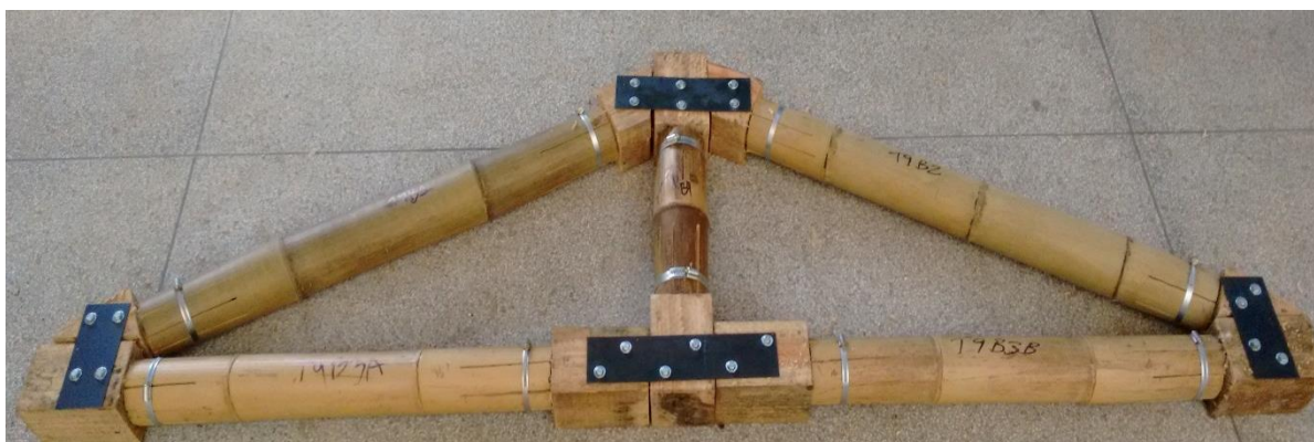
Figura 39 - Treliça tipo 3 finalizada
