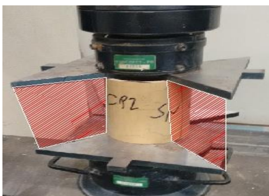
Figura 29 - Ensaio nº4: planos de cisalhamento
