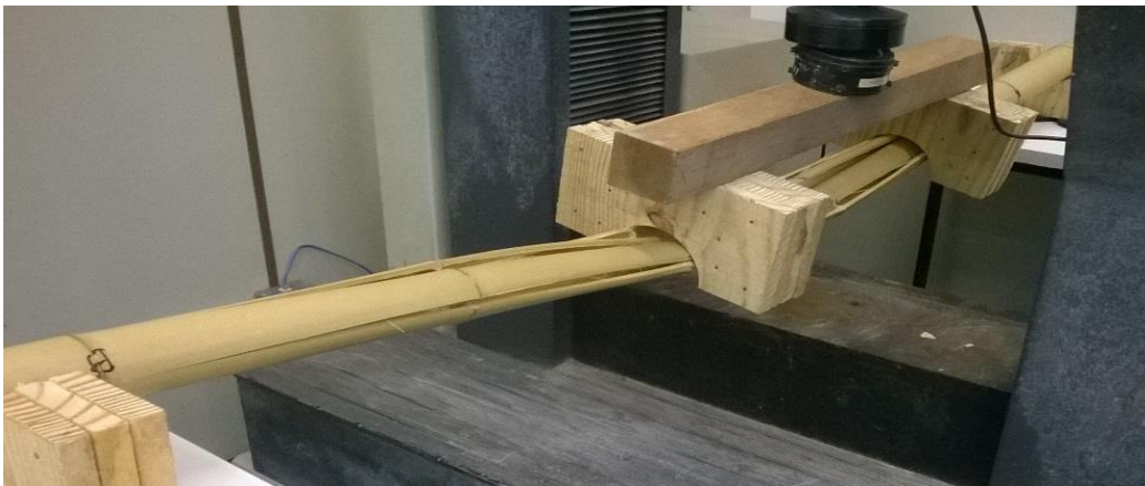
Figura 42 - Ocorrência do colapso
