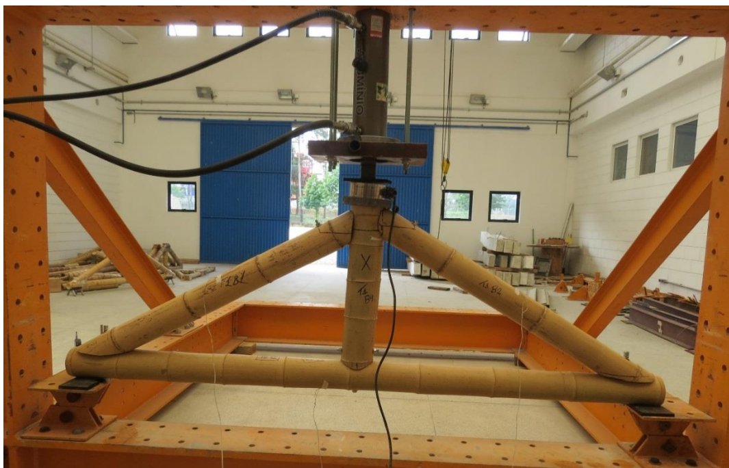
Figura 40 - Treliça preparada para início do ensaio
