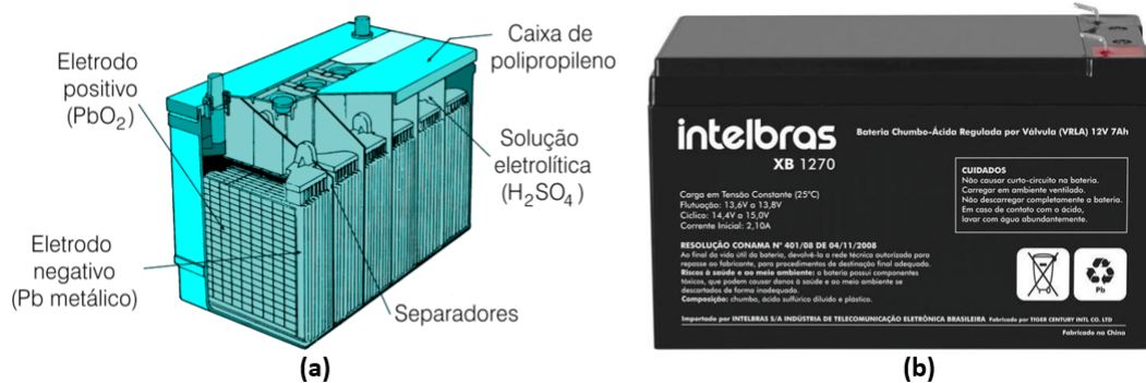
Figura 19 – Bateria de Chumbo-Ácido - (a) composição e (b) exemplo comercial
