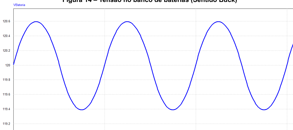
Figura 14 – Tensão no banco de baterias (Sentido Buck)
