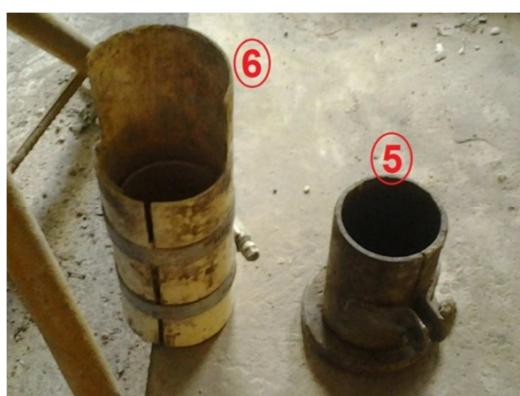
Figura 21 - Molde de corpo de prova de (5 cm x 10) cm (item 5) e adaptador da haste (item 6). Fonte: Autoria própria
