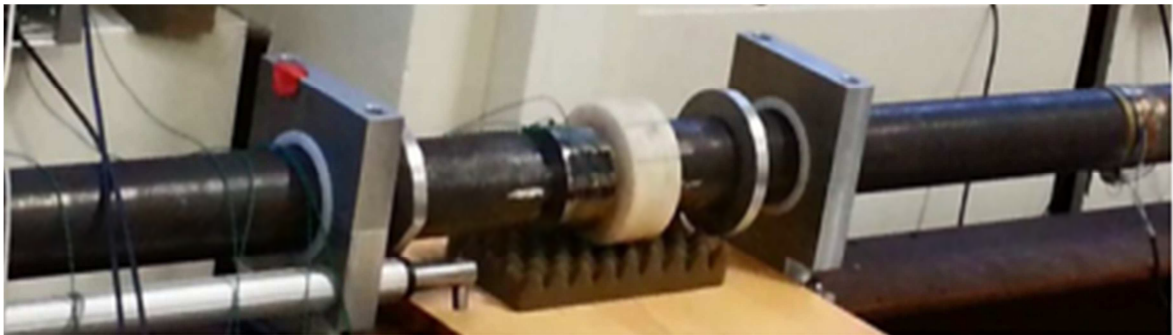
Figura 4 - Dispositivo do SHPB (barra de pressão de Split Hopkinson) Fonte: Forquin et. al. (2015)
