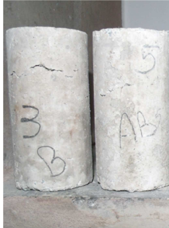
Figura 27 – Corpos de prova sem fissuras transversais e bom acabamento aparente Fonte: Autoria própria
