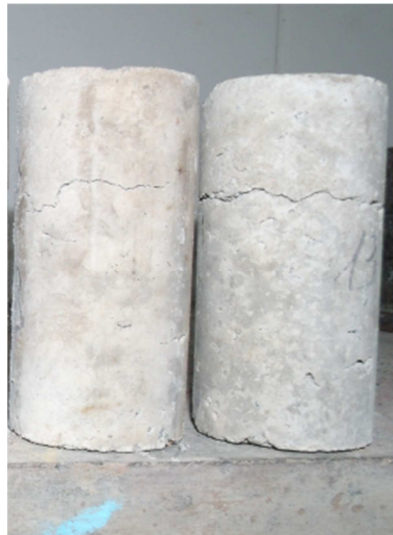
Figura 26 - Fissura transversal, oriunda pela falta de “agulhamento” entre camadas Fonte: Autoria própria
