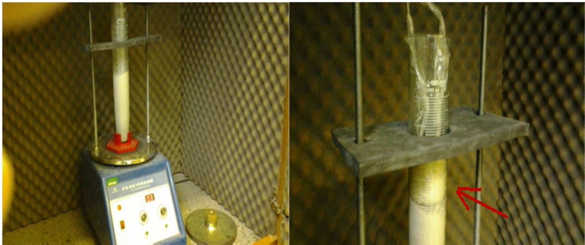
Figura 17 - Travamento lateral da proveta (figura a esquerda), detalhe do peso utilizado (figura a direita). Fonte: Autoria própria
