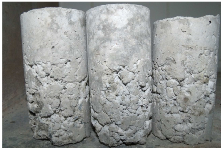
Figura 24 - Inspeção visual e constatação de falhas nos corpos de prova Fonte: Autoria própria
