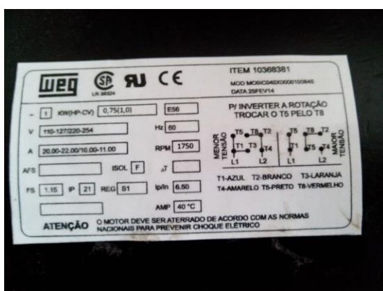
Placa de identificação do motor 5
