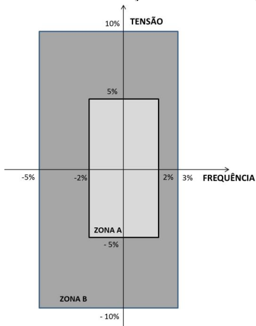
Figura 11 – Limites de variação de tensão e frequência.
