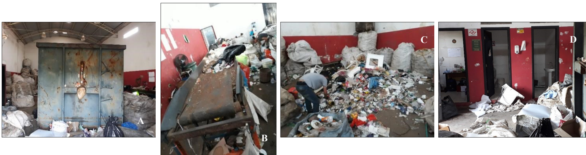
Figura 24 – Condições de operação da Cooperativa de Porto Feliz, ano de 2020. A - Galpão mal ventilado. B - Estado de deterioração da esteira de triagem. C - Material sendo triado diretamente do chão da cooperativa. D- Banheiros da cooperativa.
