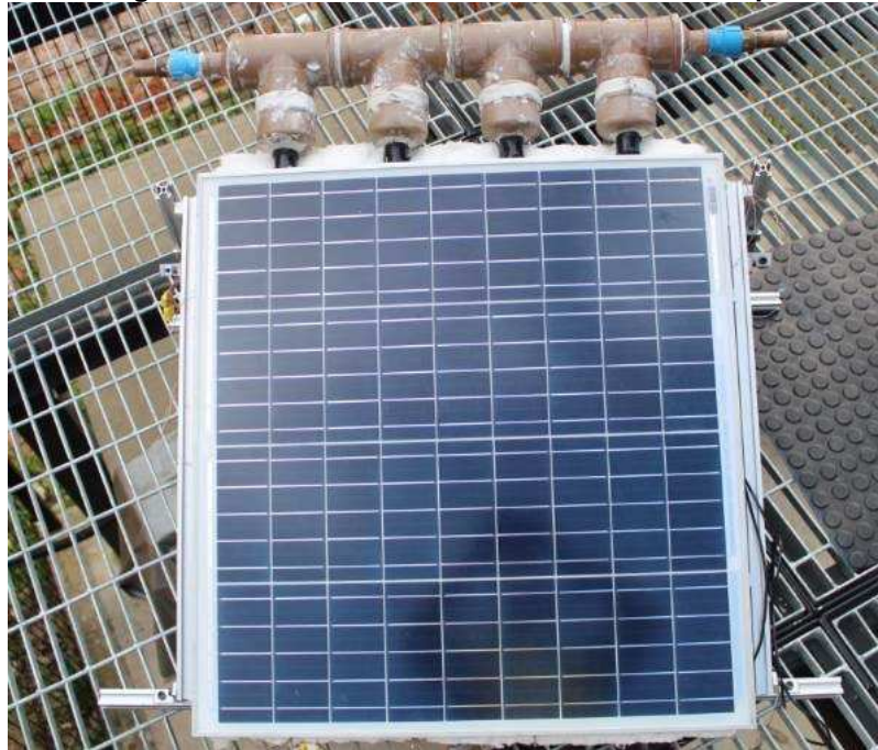
Fotografia 16 – Sistema PV/T montado em seu suporte
