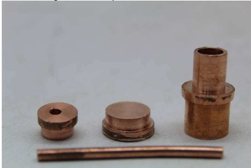
Fotografia 19 – Componentes de um termossifão
