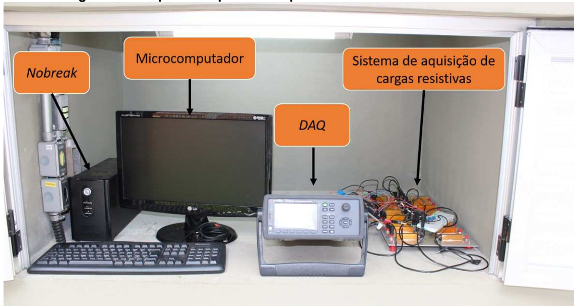
Fotografia 18 – Aparato experimental para coleta de dados do sistema PV/T
