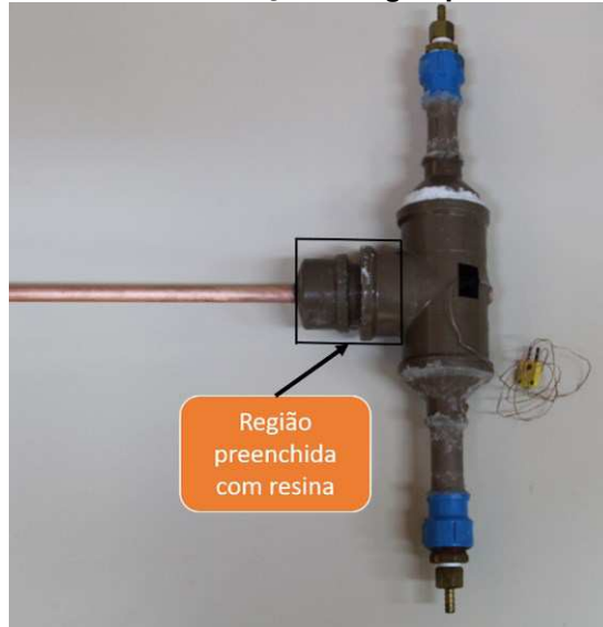
Fotografia 28 – Sistema de circulação de água para teste dos termossifões
