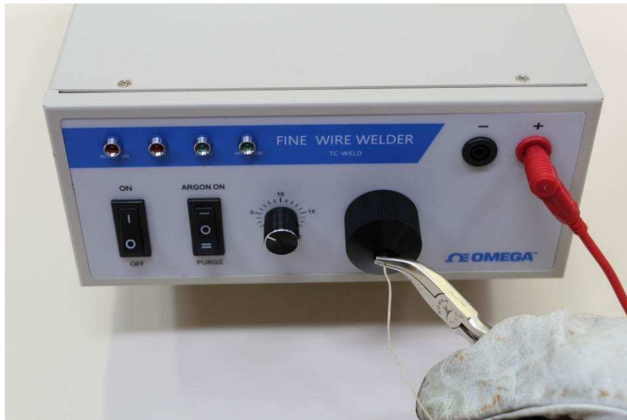
Fotografia 30 – Processo de soldagem do termopar
