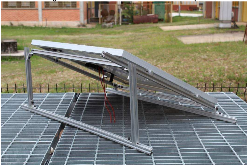
Fotografia 11 – Painel fotovoltaico comercial no suporte
