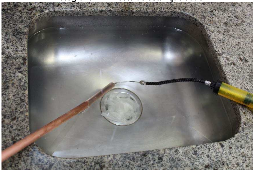
Fotografia 22 – Teste de estanqueidade
