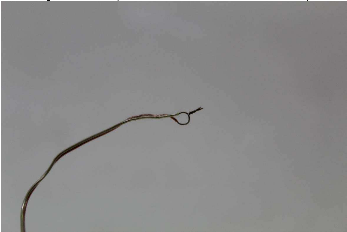
Fotografia 29 – Entrelaçamento dos materiais semicondutores do termopar
