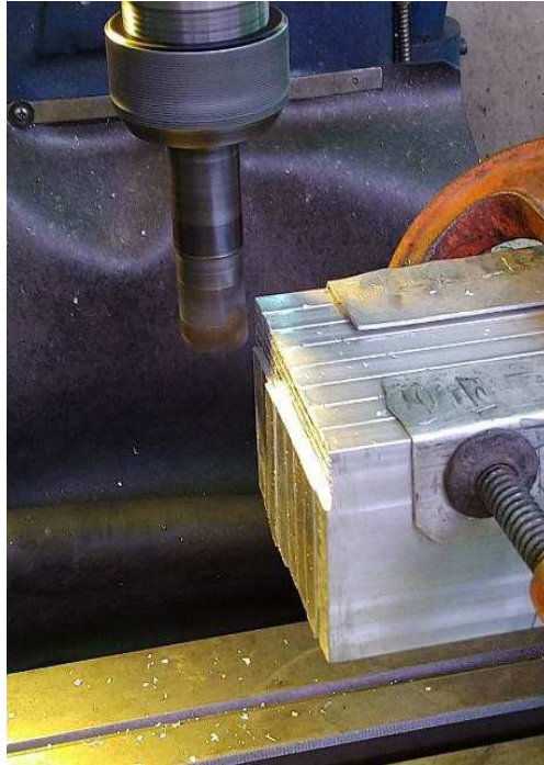
Fotografia 9 – Fresamento lateral das barras de alumínio
