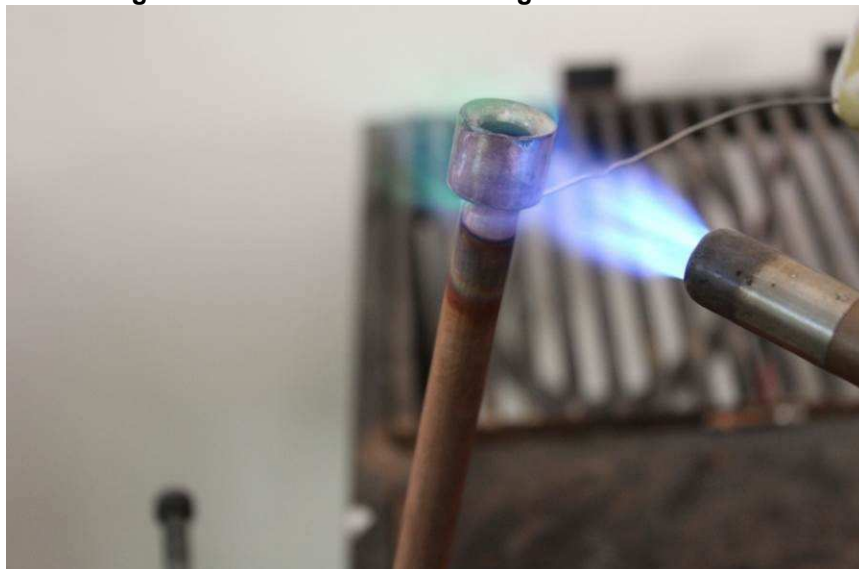
Fotografia 21 – Processo de montagem dos termossifões
