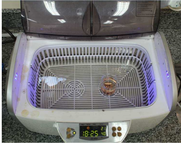
Fotografia 20 – Limpeza dos componentes por banho ultrassônico
