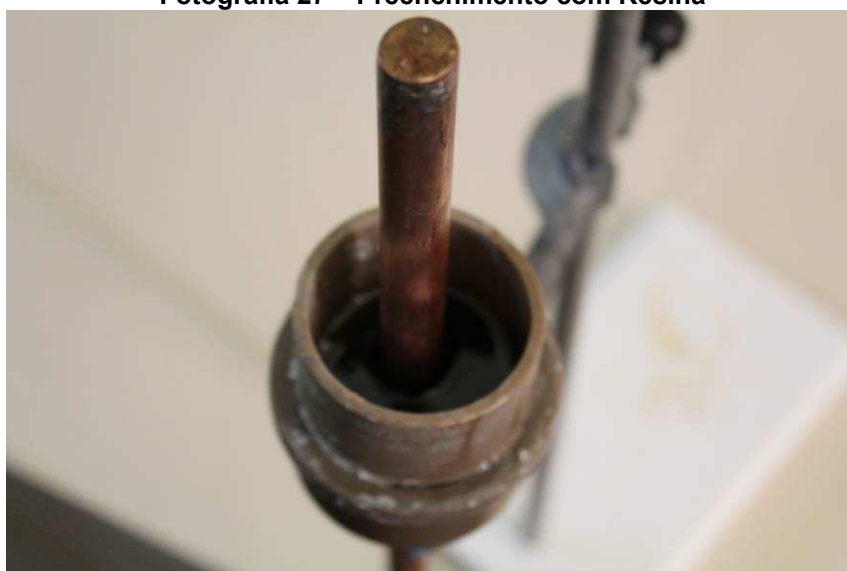
Fotografia 27 – Preenchimento com Resina
