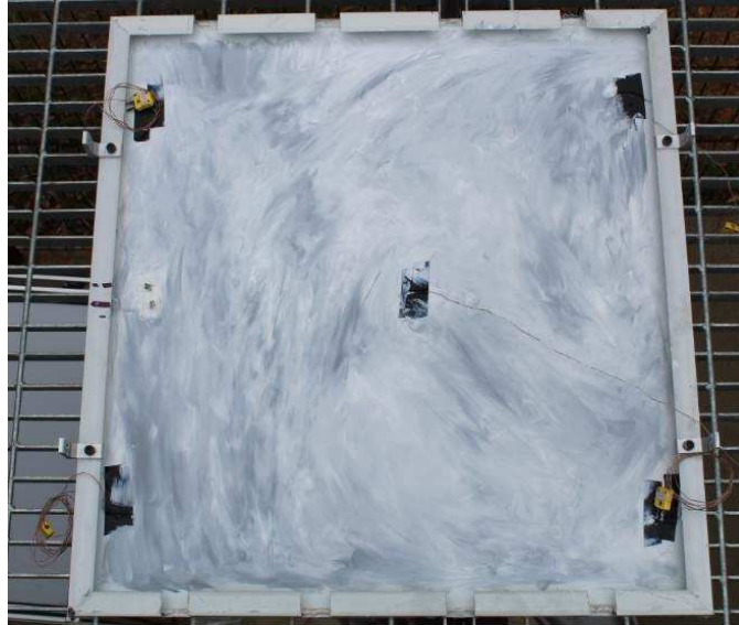
Fotografia 14 – Aplicação de pasta térmica na base do painel fotovoltaico
