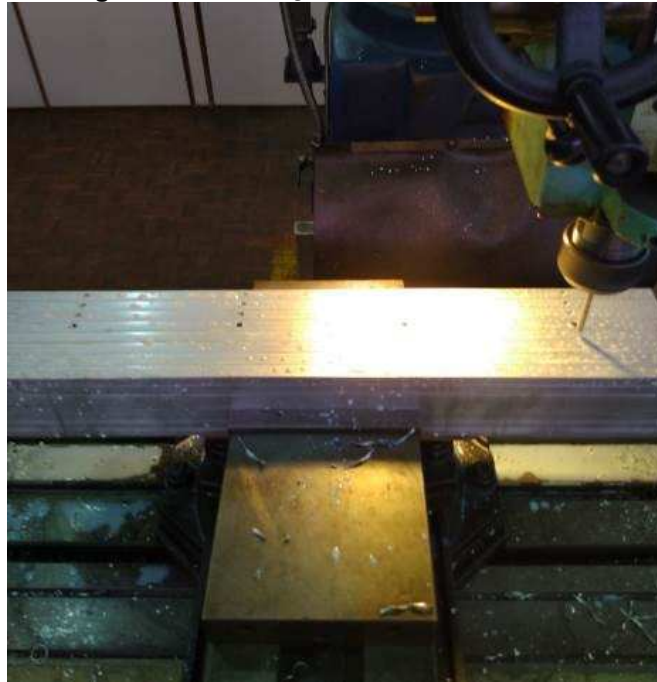
Fotografia 10 – Furação das barras de alumínio
