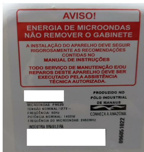
Figura 5.2 – Informações sobre o micro-ondas usado no experimento
