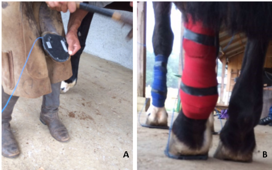
Figura 3.7: Fixação de uma ferradura no membro TE através do método de ferrageamento tradicional (A) e imagem do animal já calçado com as ferraduras instrumentadas nos dois membros torácicos e no membro pélvico esquerdo (B).
