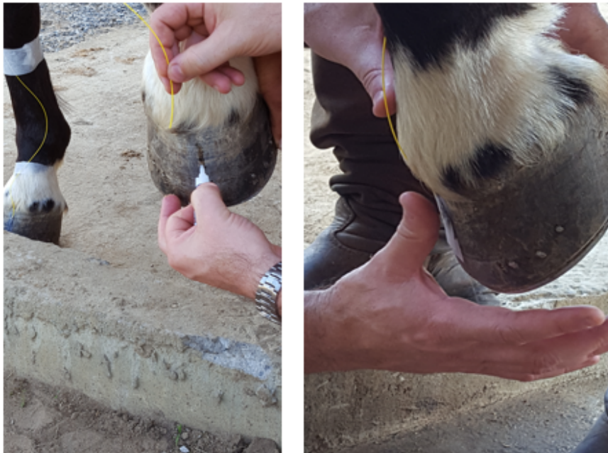
Figura 3.1: Processo de colagem das FBGs nos cascos.
