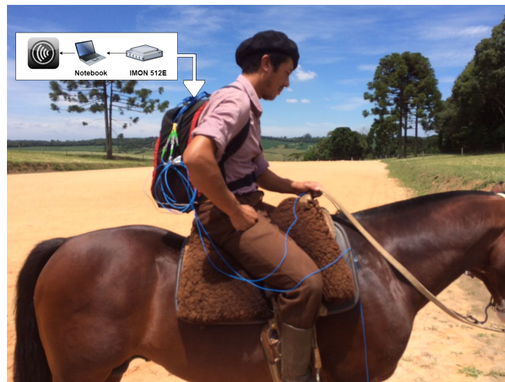
Figura 3.8: Demonstração do transporte do sistema de aquisição utilizado no ensaio com os cascos dos membros torácicos instrumentados.
