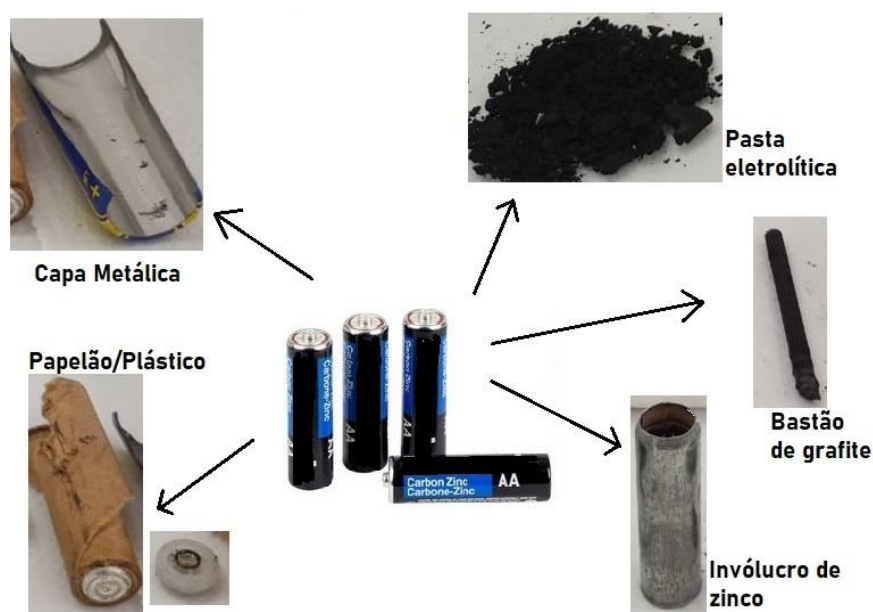
Figura 1 – Principais componentes da pilha zinco-carbono
