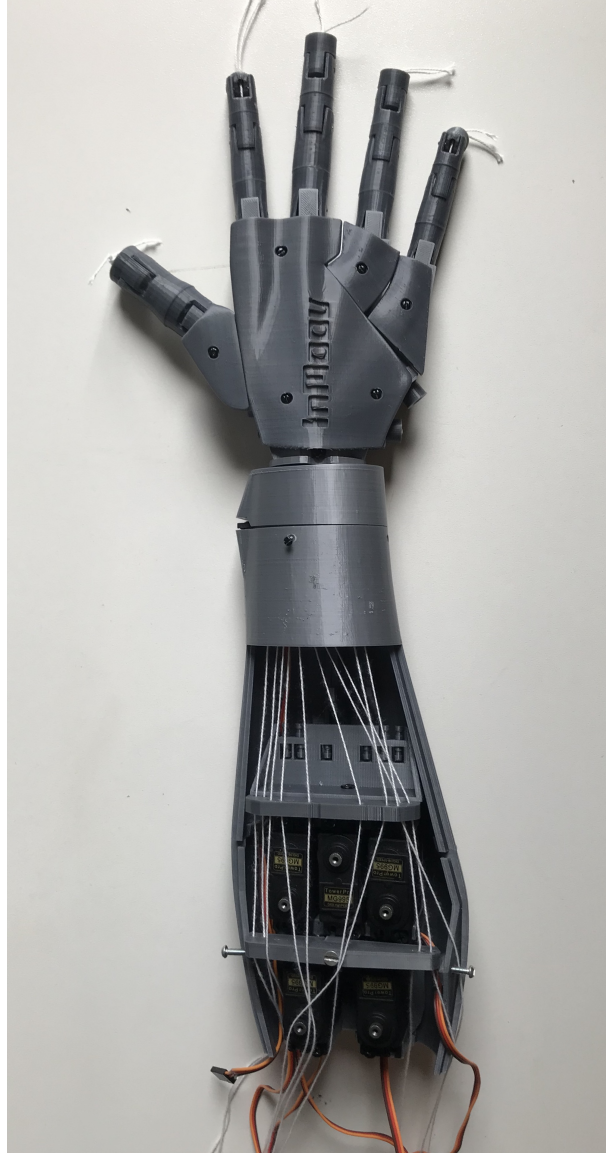
Figura 9: Fotografia da mão e do antebraço com servomotores
