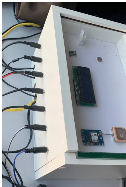
Figura 44 – Conexões externa dos sensores no dispositivo
