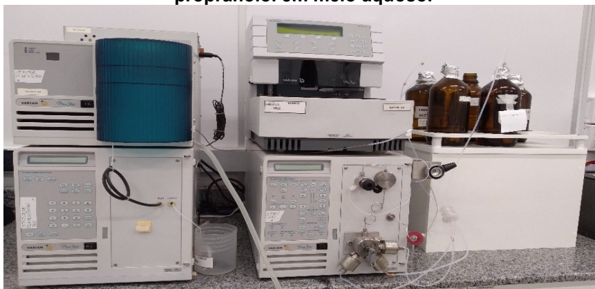
Figura 19 – HPLC utilizado na determinação da concentração do cloridrato de propranolol em meio aquoso.
