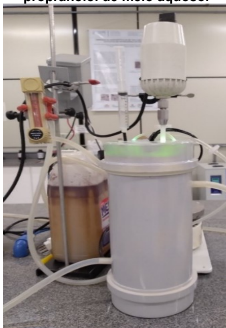
Figura 17 – Reator fotocatalítico empregado nos testes de degradação do cloridrato de propranolol de meio aquoso.
