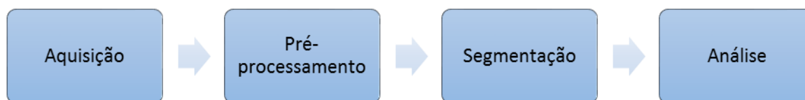
Figura 12 - Etapas básicas do Processamento de Imagens. Fonte: Adaptado de Martin Neto, Vaz e Crestana, 2007.
