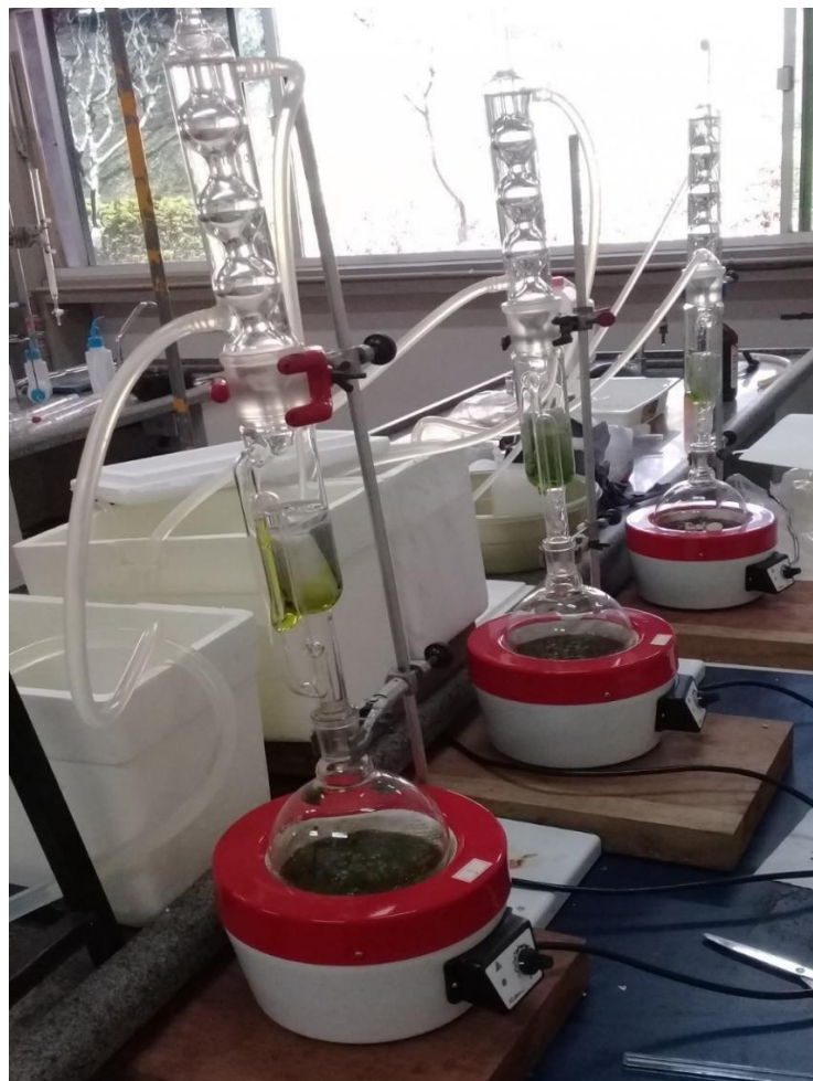
Figura 18. Sistema de resfriamento para extrator Soxhlet em série.
