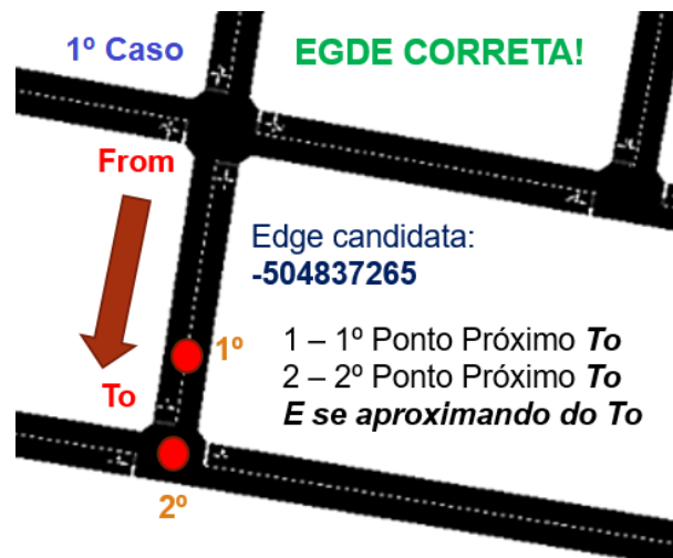
Figura 15 – Exemplo de análise para o mapeamento da primeira edge , no qual ambos os pontos de posicionamento se encontram mais próximos do node "to", indicando que a edge representa o sentido correto do mapeamento.
