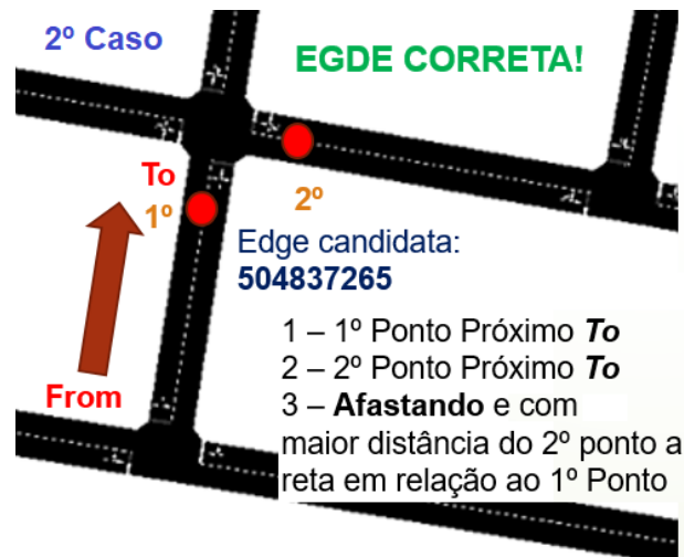
Figura 16 – Exemplo de análise para o mapeamento da primeira edge , no qual o primeiro ponto de posicionamento se encontra mais próximo do node "to" e o segundo ponto se encontra afastado da reta traçada entre os nodes da edge candidata.
