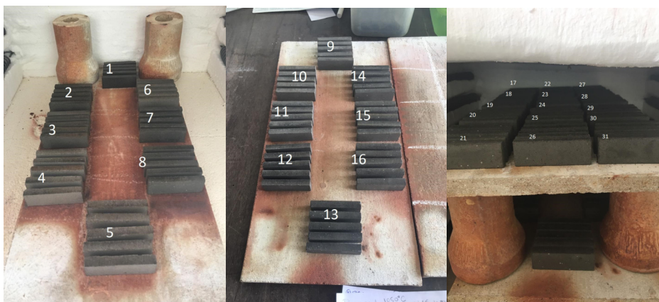
Figura 03 – Composições após a queima de 850°C antes do resfriamento
