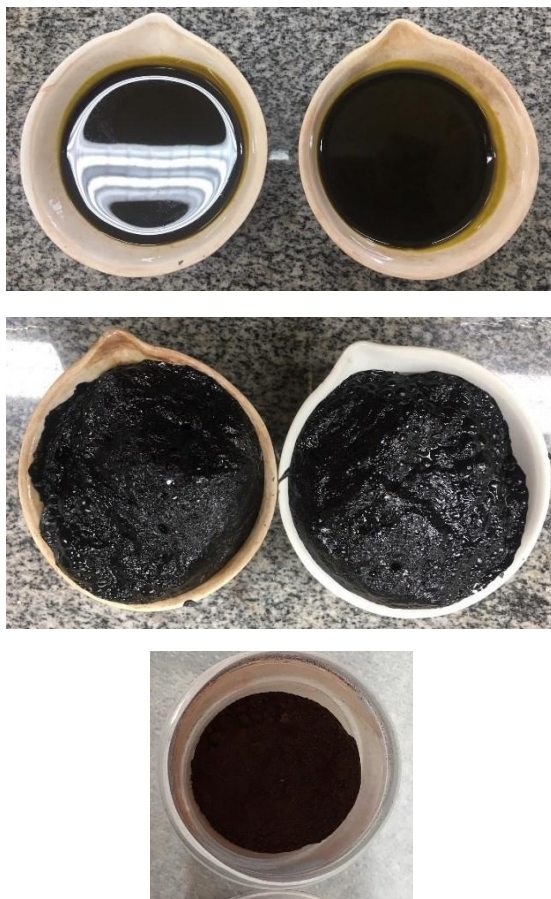
Figura 20 – Resina polimérica (primeira imagem) após a secagem em estufa (segunda imagem) e após a calcinação (terceira imagem). Fonte: autoria própria
