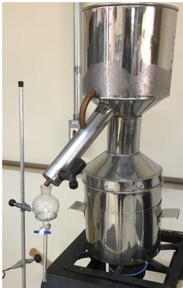
Fotografia 3 - Sistema adaptado para obtenção de óleo essencial por arraste a vapor em laboratório Fonte: Autorial própria (2021)
