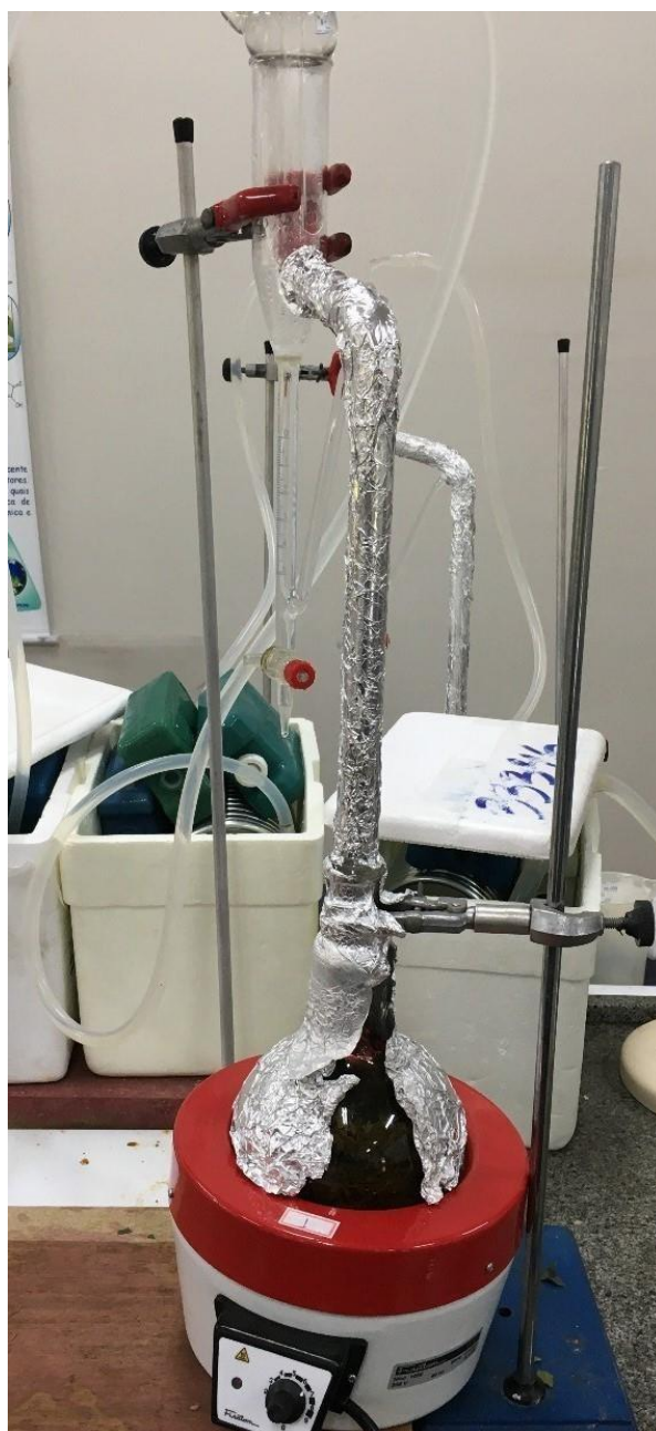
Fotografia 4 - Aparato Clevenger acoplado à manta aquecedora para obtenção de óleo essencial por hidrodestilação em laboratório Fonte: Autoria própria (2021)
