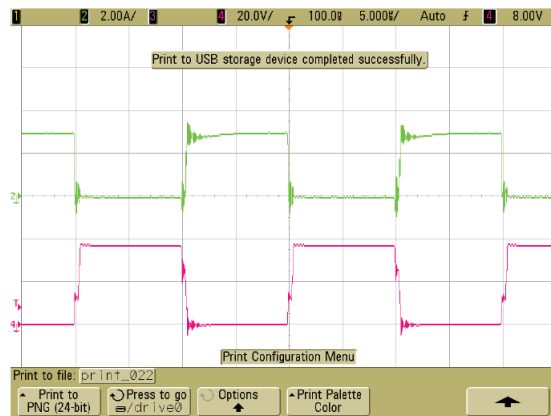
(c) Formas de onda da corrente na chave (de cima) e tensão sobre a chave (de baixo). Com 50% de carga I_o = 5 A.
