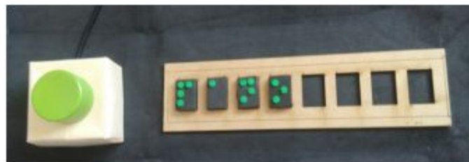
Figura 5.9: Protótipo de TUI mínima em EVA e MDF de Forcelini et al. (2018) (Fonte: Forcelini et al. (2018, Fig. 2, p. 43))
