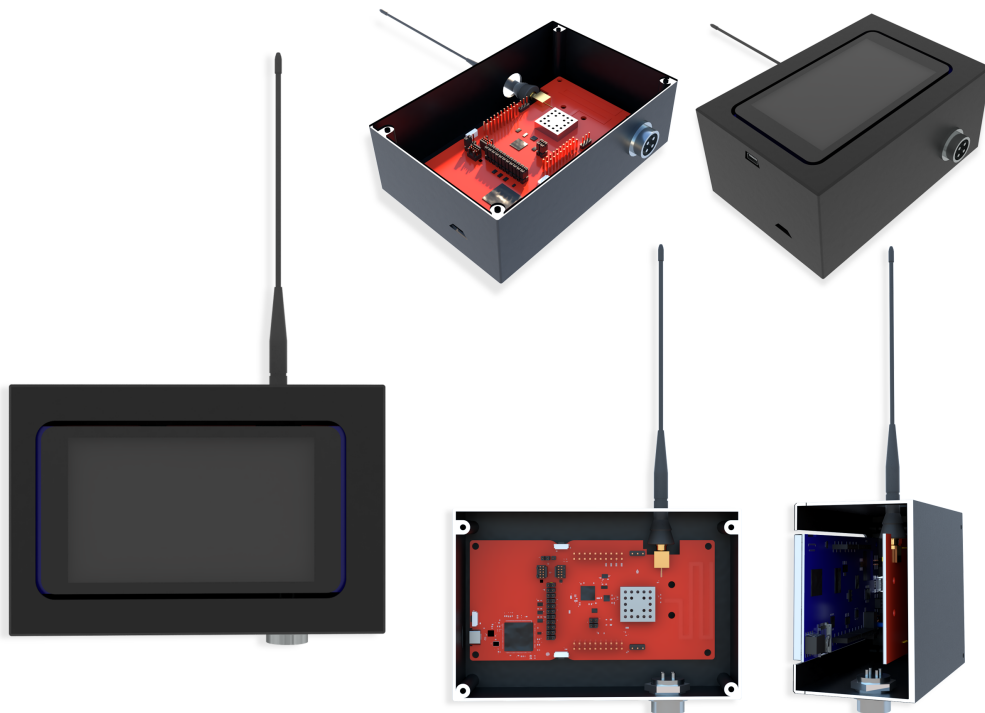
Figura 27 – Projeto do invólucro do subsistema SnifferCAN
