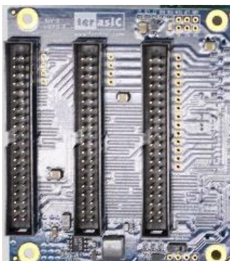
Figura 10 - Placa de interface de conectores HSMC para GPIO de 40 pinos da FPGA Cyclone III modelo THDB-HTG fabricada pela Terasic Technologies.
