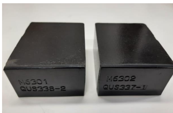
Figura 14 - Phantoms para simulação de tecido ósseo normal (M06301 - QUS338-2) e osteoporótico (M06302 - QUS337-1), fabricado pela CIRS Inc.
