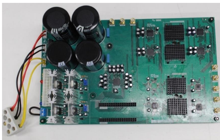
Figura 5 - Placa de transmissão e recepção de sinais de ultrassom desenvolvida (TX_RX_ULTRASSOM).
