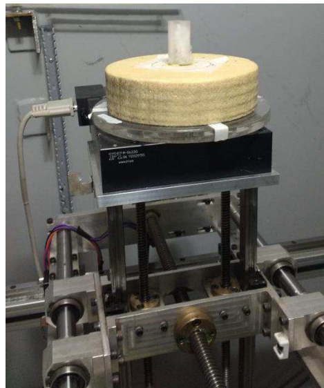
Figura 22 - Fixação do phantom no porta amostra giratório.
