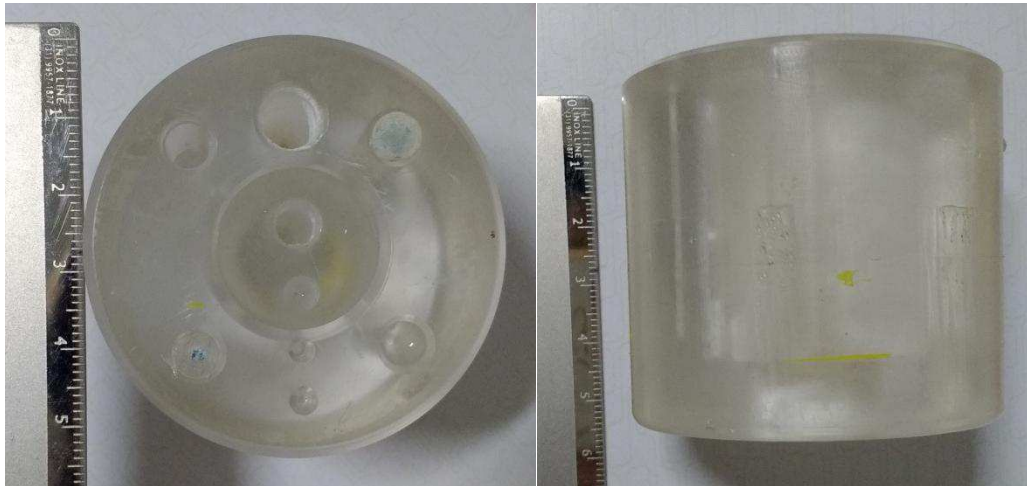
Figura 28 - Vista superior e lateral do phantom.
