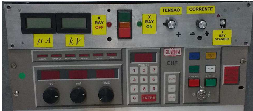
Figura 23 - Painel de comando do gerador de raios X microfoco da Thermo Kervex.
