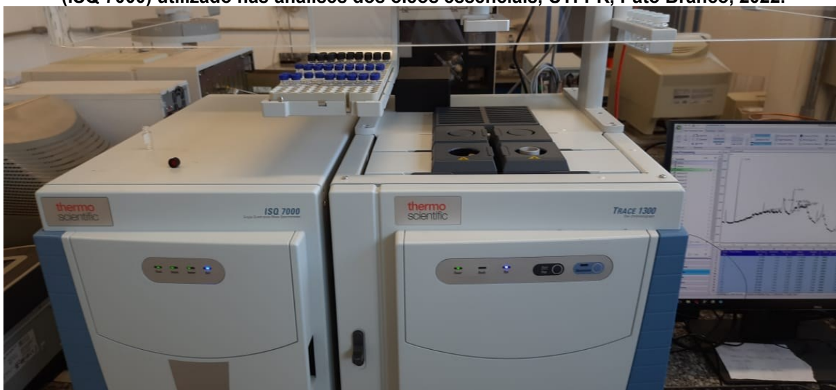
Figura 6 - Cromatógrafo a gás (TRACE 1310 SERIES) acoplado a espectrômetro de massas (ISQ 7000) utilizado nas análises dos óleos essenciais, UTFPR, Pato Branco, 2022.
