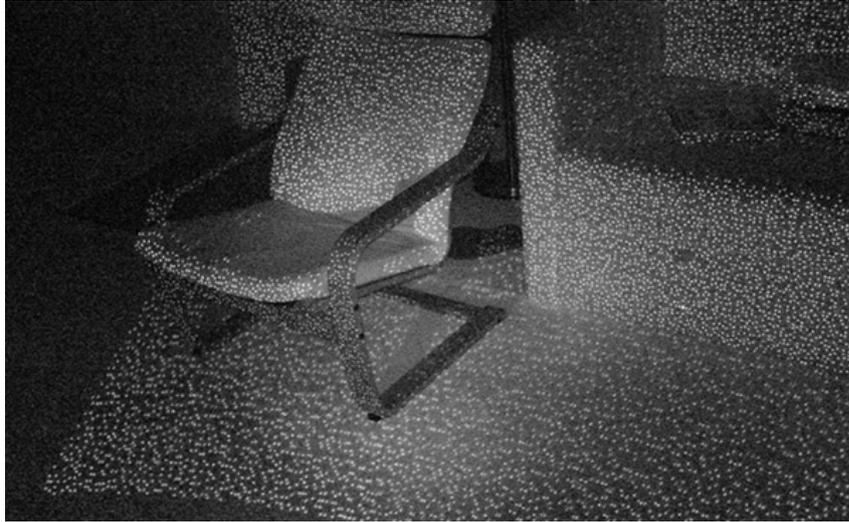
**Figura 9:** Exemplo de luz estruturada utilizado pelo sensor Kinect, a imagem foi obtida com a ajuda de um sensor capaz de capturar infravermelho.
