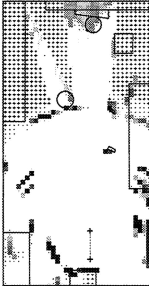
**Figura 15:** Exemplo Grades de Certeza: Células ocupadas estão representadas por quadrados sombreados, células desocupadas estão na cor branca e células com incerteza representadas com o sinal “+”.
