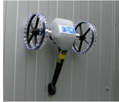
**Figura 5:** Robô magnético.
