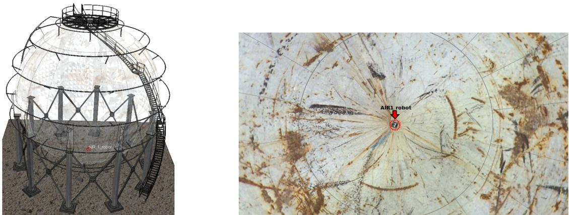
**Figura 42:** Vaso de pressão esférico e robô AIR-1 simulados. À esquerda: Vista de fora do vaso de pressão. À direita: vista interna do vaso de pressão esférico simulado.
