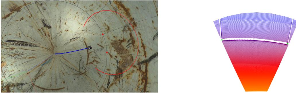
**Figura 44:** Correção de proximidade com o uso da câmera de meio-alcance. À esquerda: visão interna do vaso de pressão esférico simulado com a rota feita pelo robô marcada em azul. À direita: nuvem de pontos da câmera de profundidade meio-alcance com o cordão de solda identificado.
