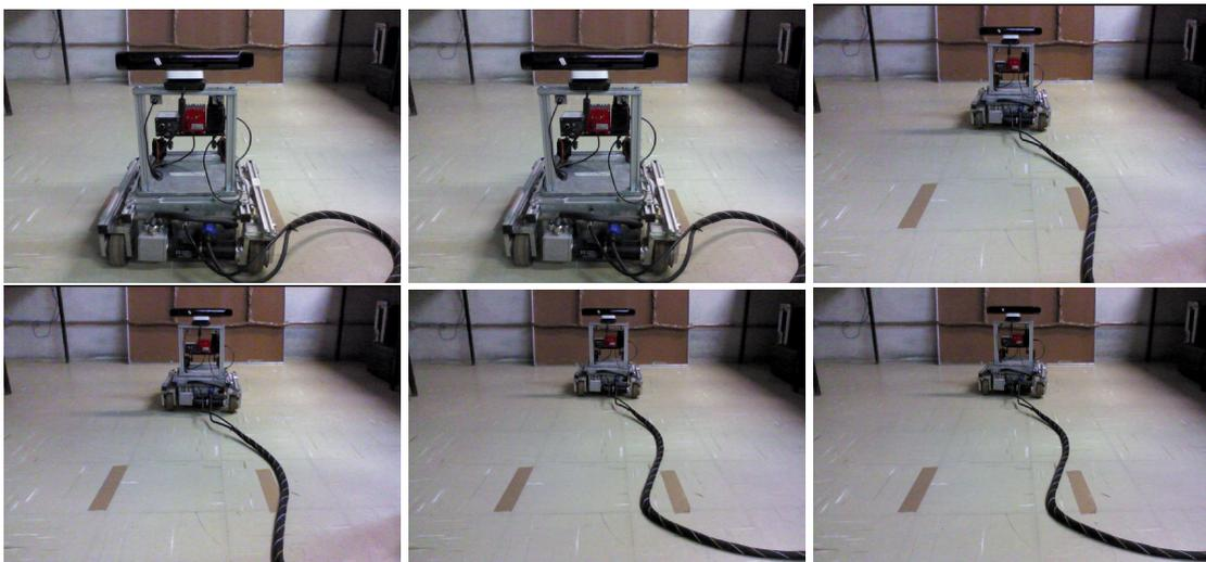
**Figura 54:** Validação da busca autônoma do ponto de observação padrão com o quadro ao centro. À esquerda superior: Posição inicial, a 1,5 metros do quadro. Ao centro superior: correção angular. À direita superior: correção linear chegando a 1 metro do quadro. À esquerda inferior: correção angular. Ao centro inferior: correção linear chegando a 0,7 metros do quadro. À direita inferior: Correção angular, chegando ao ponto de observação padrão.
