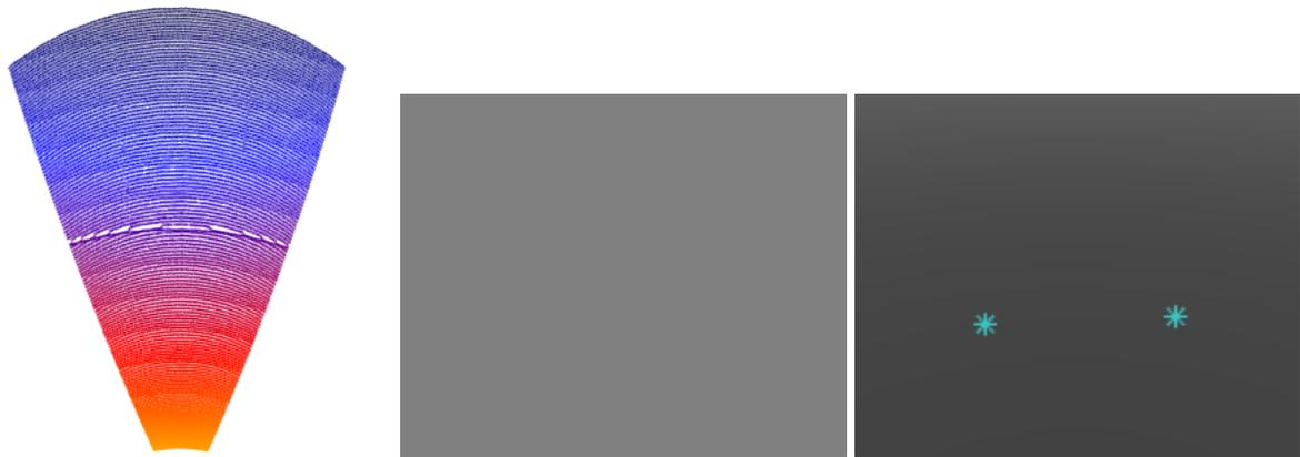
**Figura 43:** Passos para a obtenção dos entroncamentos de solda com a câmera de profundidade longo-alcance ToF. À esquerda: nuvem de pontos. Ao centro: nuvem de pontos convertida em imagem. À direita: entroncamentos de soldas identificados.
