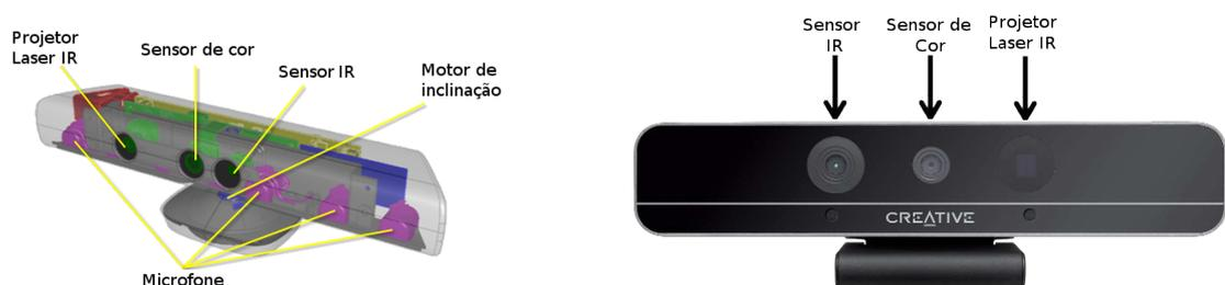
**Figura 8:** À esquerda: sensor Microsoft Kinect adaptado. À direita: sensor Intel RealSense f200.
