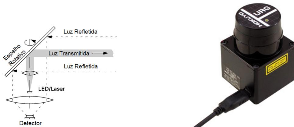
**Figura 13:** À esquerda: Esquema de funcionamento de um sensor de varredura laser. À direita: sensor de varredura laser hokuyo URG-04LX-UG01.
