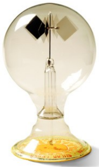
Figura 15 - Radiômetro de Crookes.
