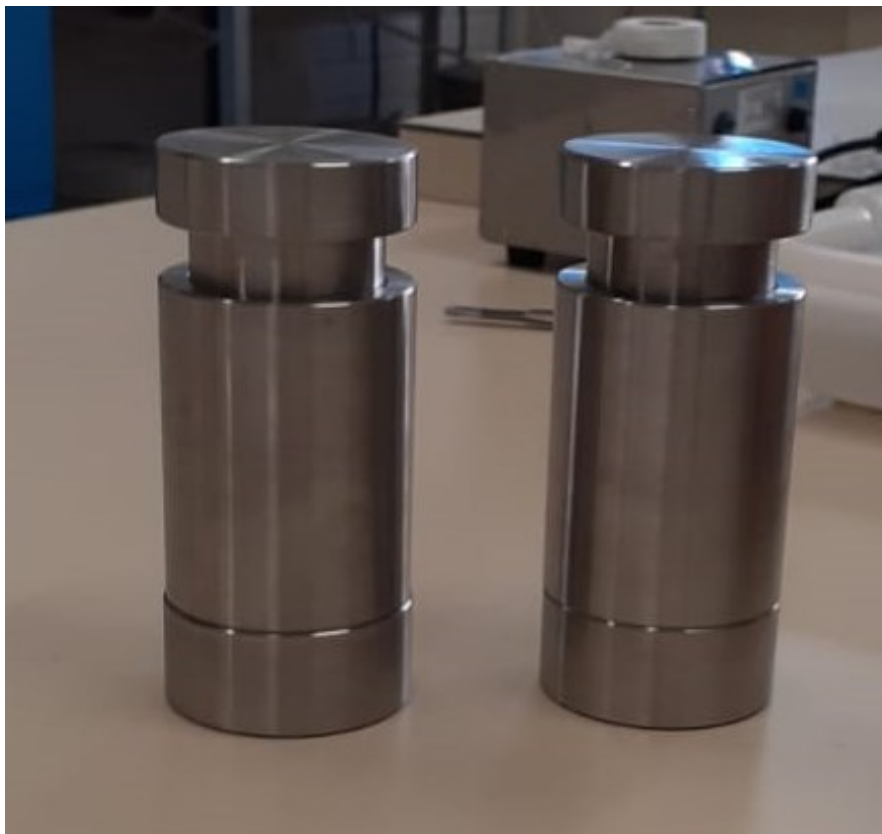
Figura 1 - Moldes de aço carbono utilizados na confecção dos corpos de prova.
