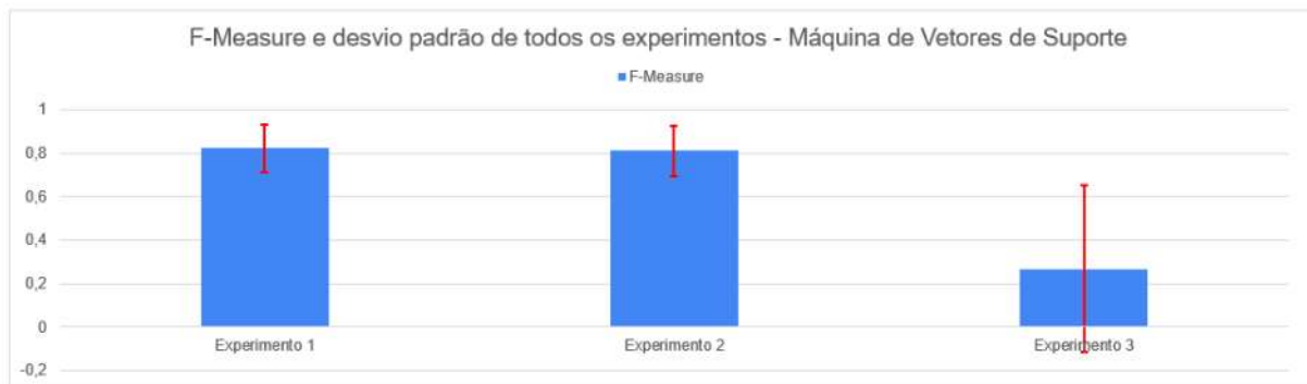
Figura 19: F-Measure e desvio padrão para cada um dos experimentos utilizando o classificador Máquina de Vetores de Suporte.
