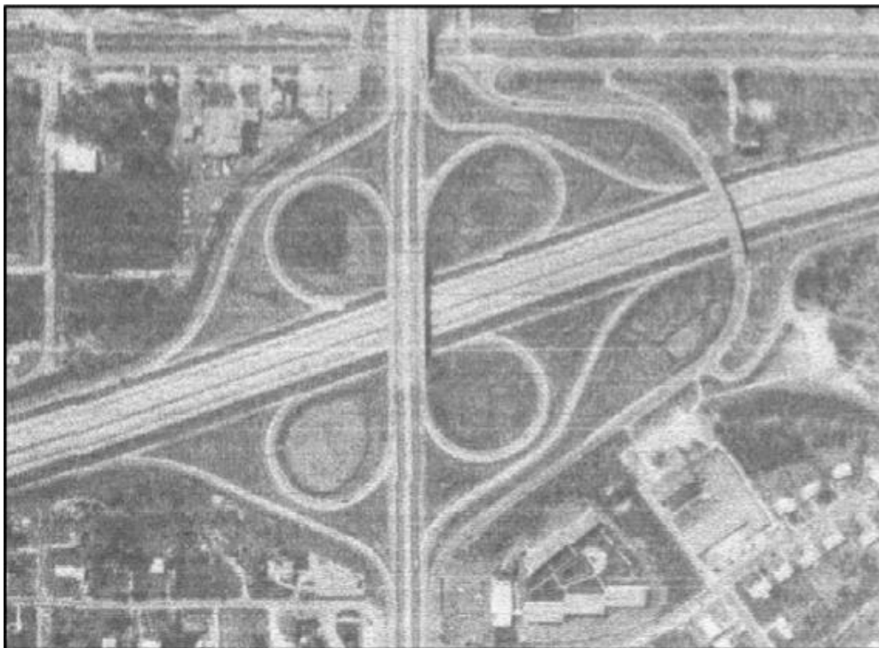
Figura 2 – Interseção em níveis diferentes (trevo completo) Fonte – Manual de Projeto Interseções (2005).
