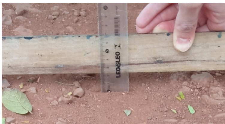
Figura 87: Medidas da profundidade da Trilha de Roda Fonte: Autoria própria (2021).
