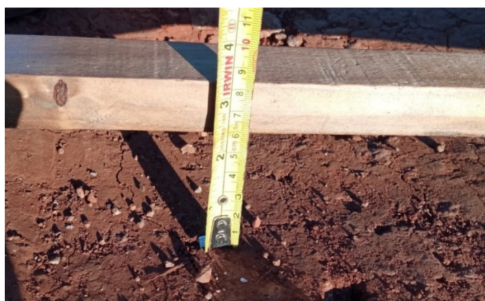
Figura 63: medida de profundidade do defeito Trilha de Roda
