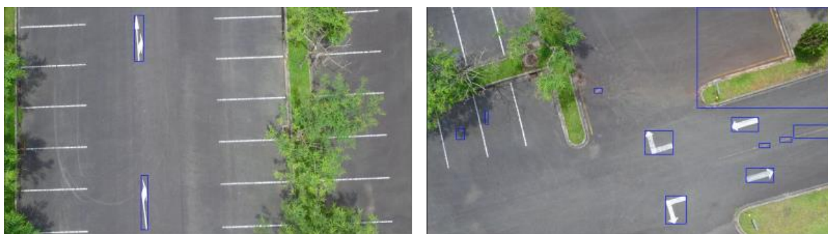
Figura 25 - Testes de segmentação de rodovia e objetos em ambiente controlado. Retângulos em azul indicam objetos identificados
