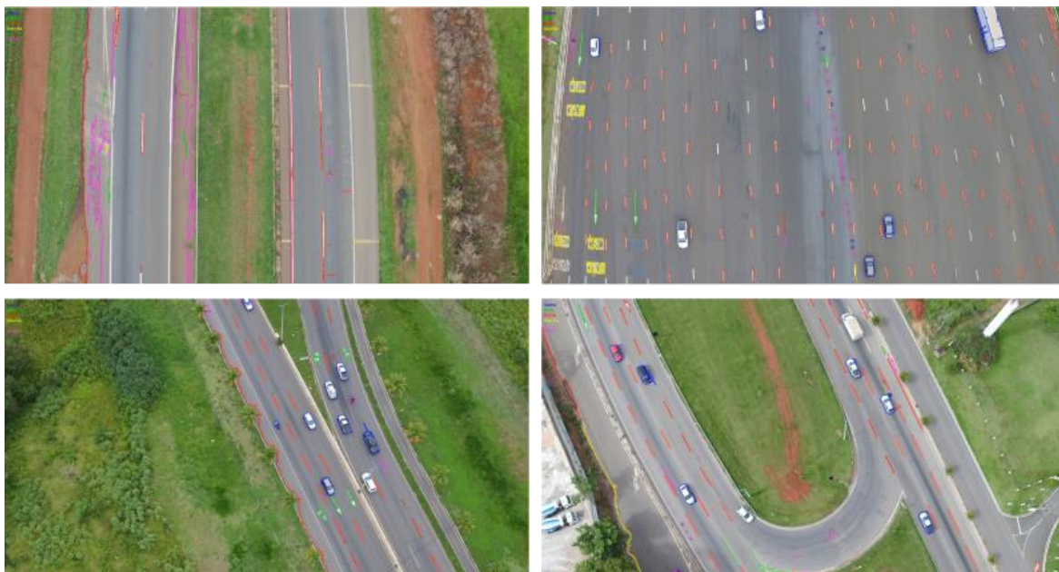
Figura 30 - Testes de classificação em ambiente real. Objetos marcados em verde foram identificados como setas, em vermelho traços, azul carros, palavras em amarelo e magenta defeitos.
