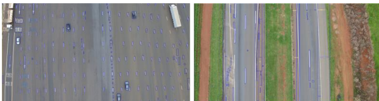
Figura 27 - Testes de segmentação de rodovia e objetos em ambiente real. Retângulos azuis indicam objetos identificados.
