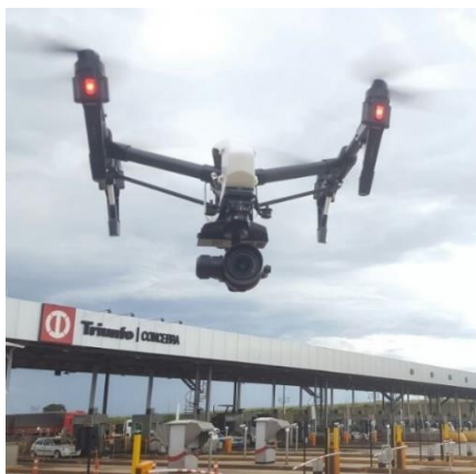
Figura 19 - VANT com câmera acoplada utilizado para aquisição das imagens.
