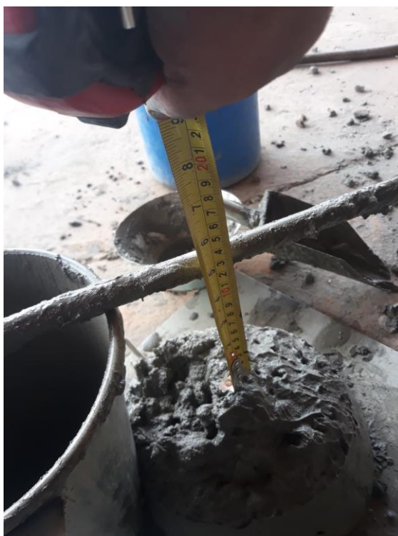
Figura 35 - Abatimento não atingido - Autoria Própria 2021
