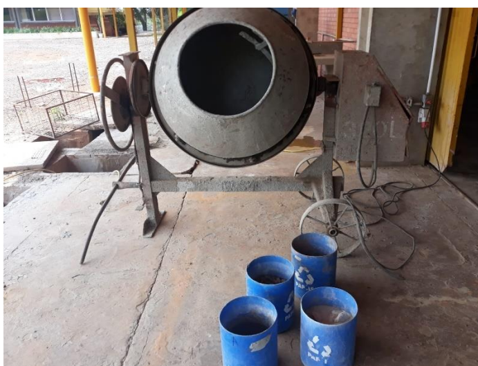
Figura 32 - Betoneira utilizada na fabricação do concreto - Autoria Própria 2021
