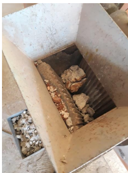
Figura 4 - Adição dos Materiais ao Triturador - Autoria Própria 2021
