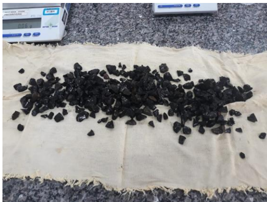
Figura 18 - Secagem Superficial dos Agregados - Autoria Própria 2021
