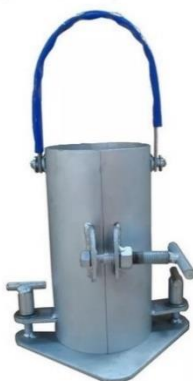
Figura 37 - Molde corpo de prova - MANUAL DO CONCRETO 2017
