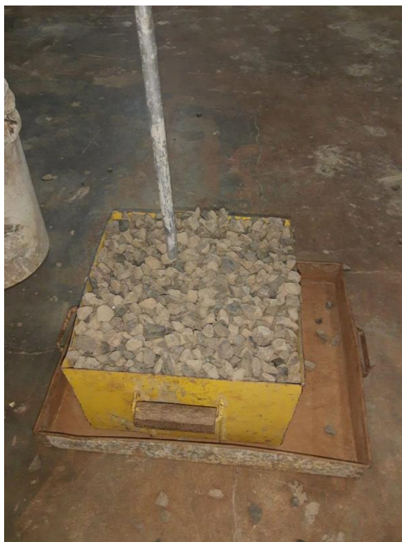
Figura 24 - Compactação com Haste Metálica - Autoria Própria 2021
