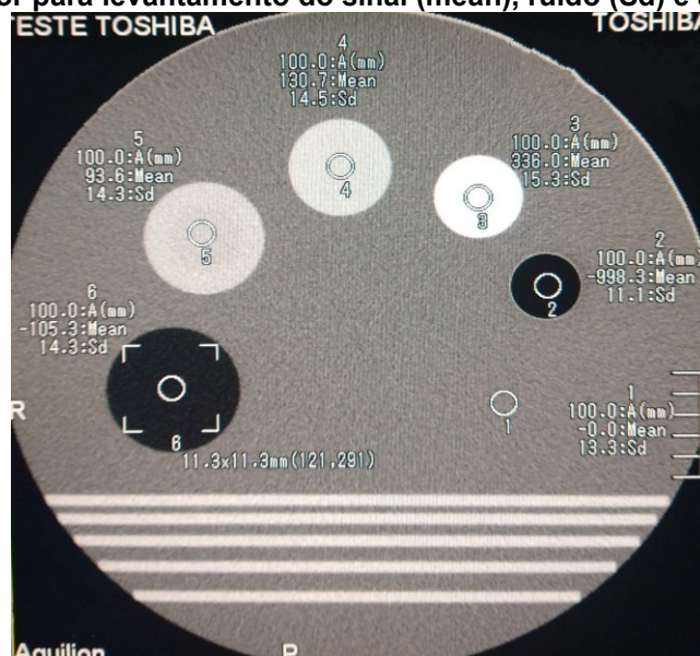
Figura 12 - Exemplo de medição com ROI posicionada em diferentes tecidos no objeto simulador para levantamento do sinal (mean), ruído (Sd) e área (mm)
