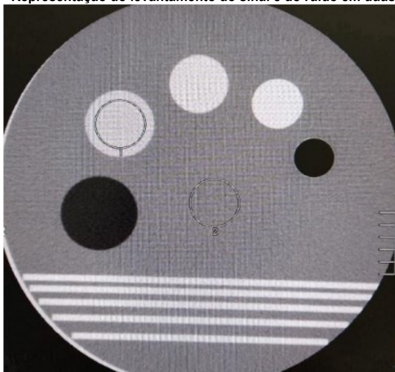
Figura 24 – Representação do levantamento do sinal e do ruído em duas estruturas
