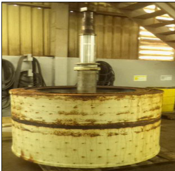
Figura 32 - Eixo principal e cesto
