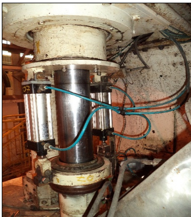
Figura 34 - Sistema Pneumático de Abertura e Fechamento de Fundo Fonte: Raízen (2015)
