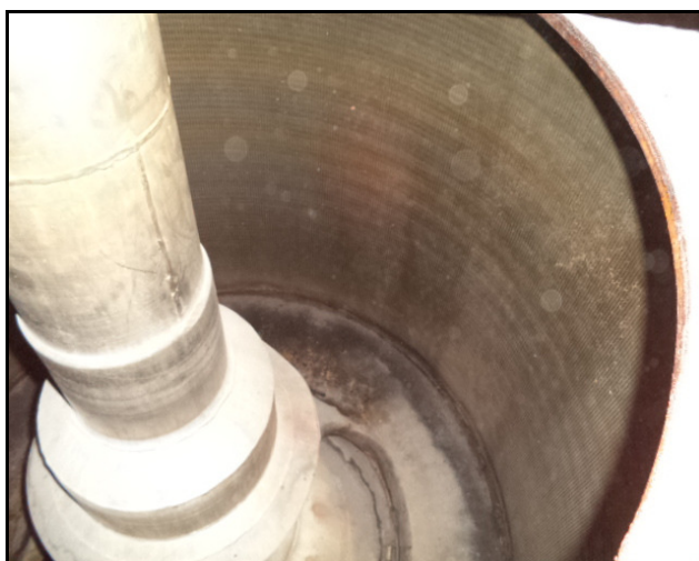
Figura 33 - Eixo principal, cesto e tela
