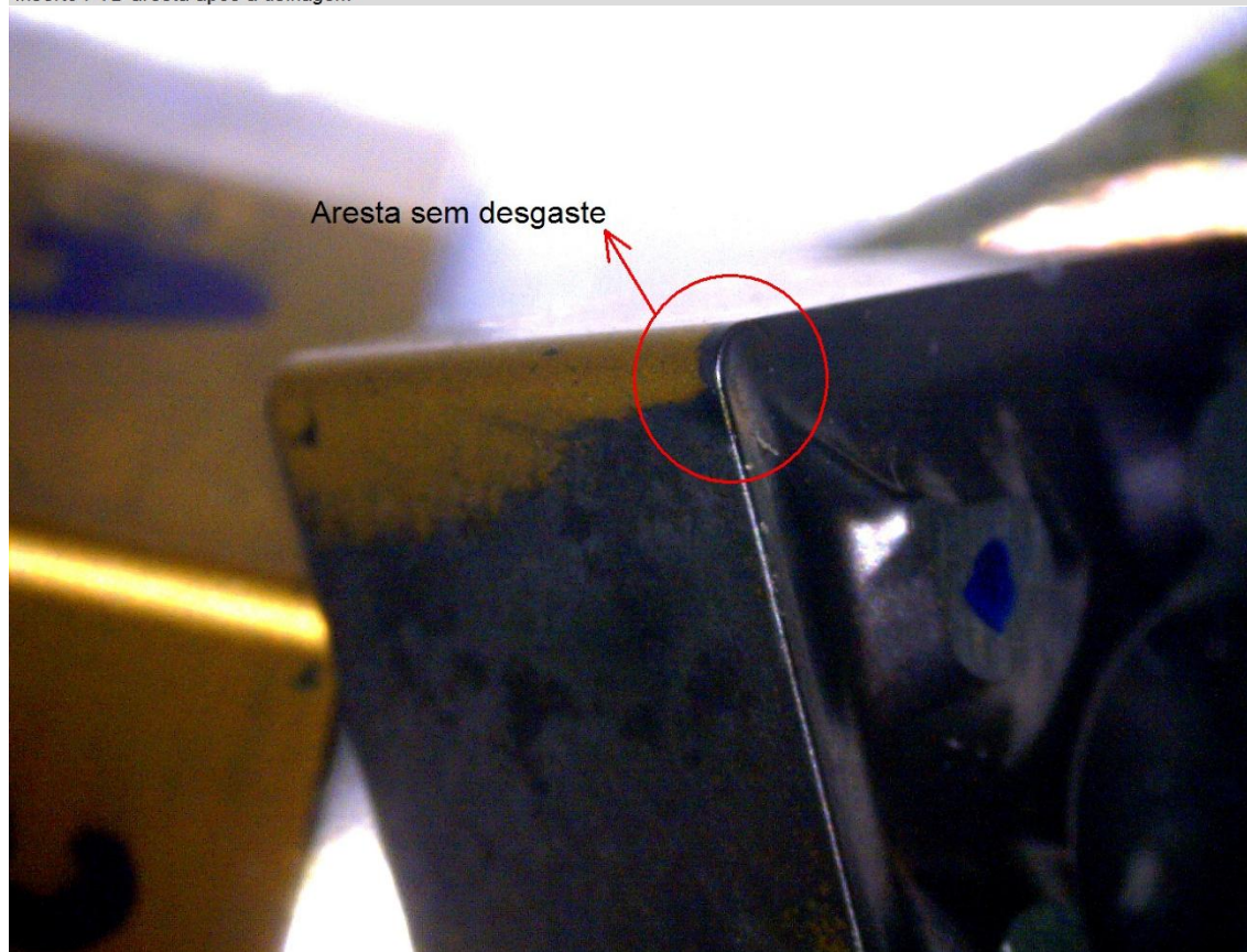
Inserto PVD aresta após a usinagem
