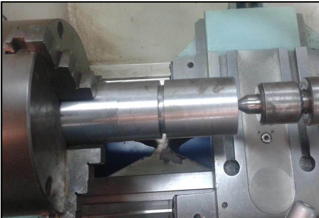
Figura 5.3 – Corpo de prova finalizado para início dos ensaios Fonte: Autoria Própria
