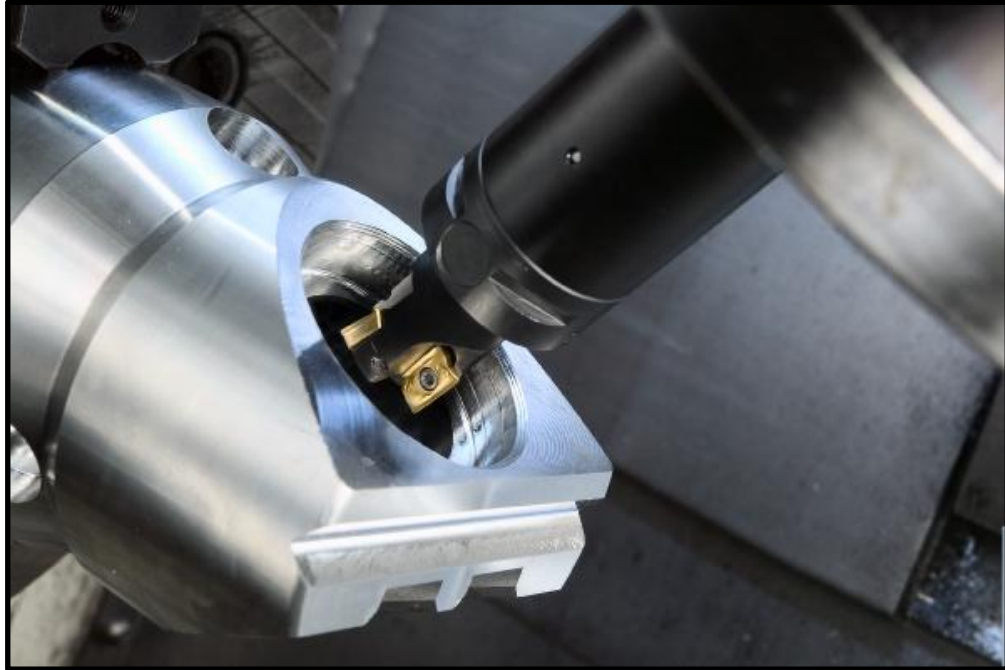
Figura 4.6 – Processo de Mandrilamento Fonte: Sandvik Coromant 2015
