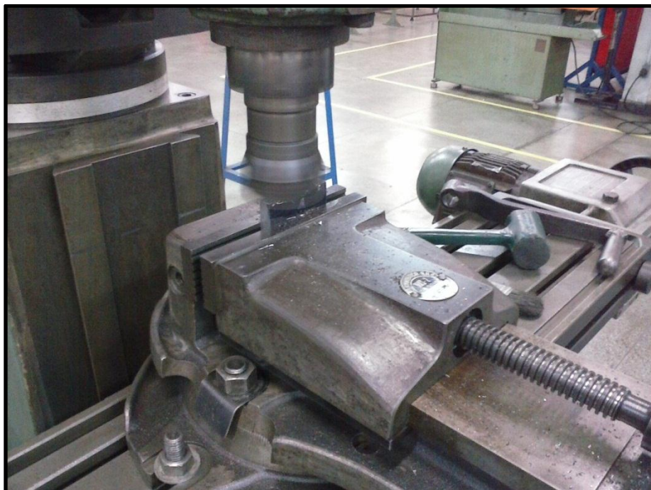
Figura 4.3 – Operação de Fresamento Fonte: Autoria Própria.
