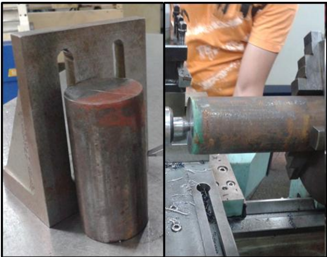
Figura 5.1 – Tarugos de Aço SAE 1045 (esquerda) e SAE 8620 (direita) utilizados. Fonte: Autoria Própria
