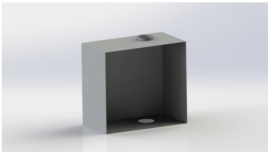
Figura 14-Estrutura Metálica de armazenamento. Fonte: Autoria própria.
