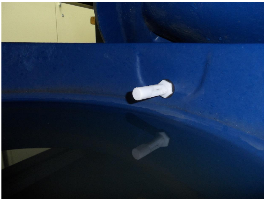
Figura 32 - Detalhe do sensor de nível Fonte: Autoria própria
