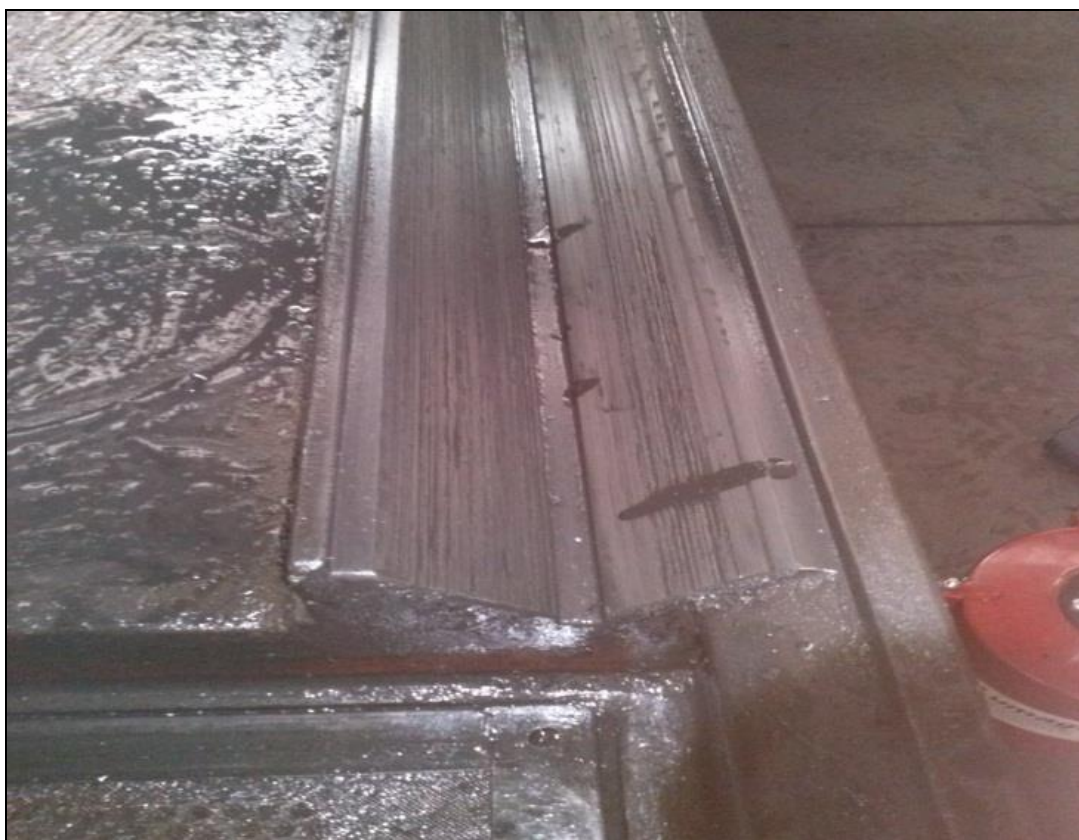
Figura 10: Barramento de uma plaina (máquina do ambiente estudado)
