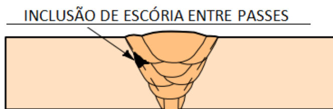
Figura 6: Inclusão de escória entre passes de solda
