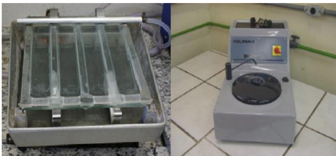
Figura 18: Métodos de lixamento (a) manual (100 – 420) e (b) semiautomático (600)
