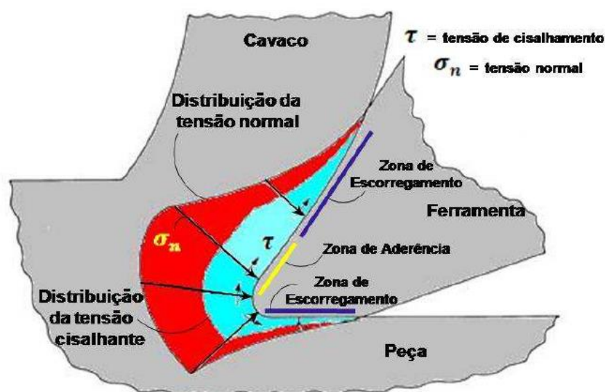
Figura 6: Modelo de distribuição das tensões normal e cisalhante Fonte: KENDALL (1995)
