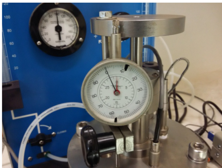
Figura 17 - Posicionamento do relógio comparador Fonte: Matsubara (2015)
