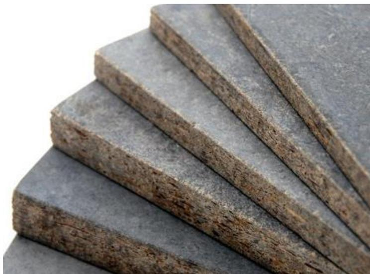
**Figura 2 - Painéis de cimento-madeira**
