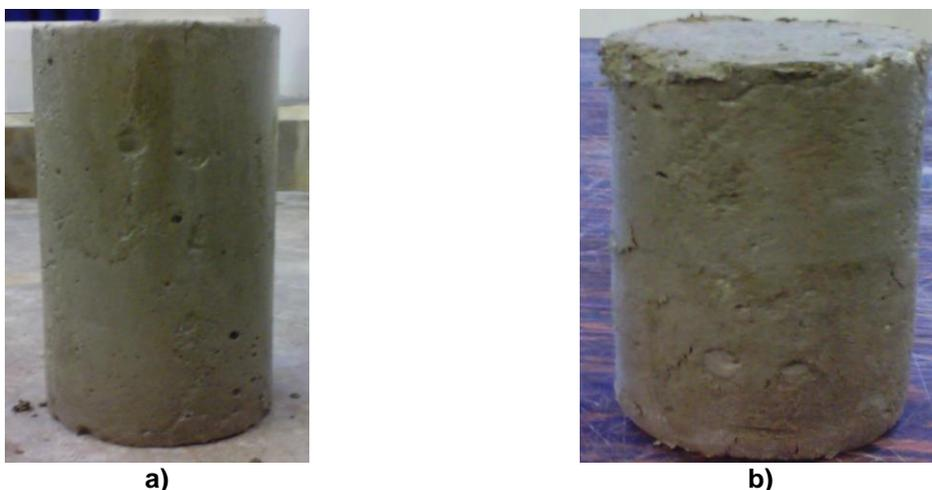
**Figura 14 - a) Corpos de prova de biomassa de cana – de açúcar b) Corpo de prova de biomassa de cana – de – açúcar após ensaiado à compressão axial**
