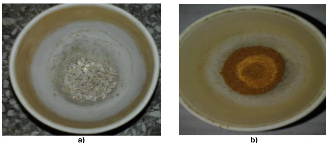
**Figura 8 - a) Cinzas do bambu mossô. b) Cinzas da cana-de-açúcar**
