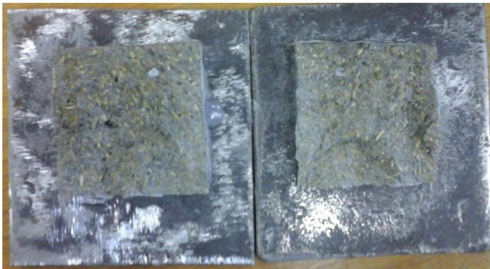
**Figura 26 – Corpos de prova de ligação interna após ensaiados**
