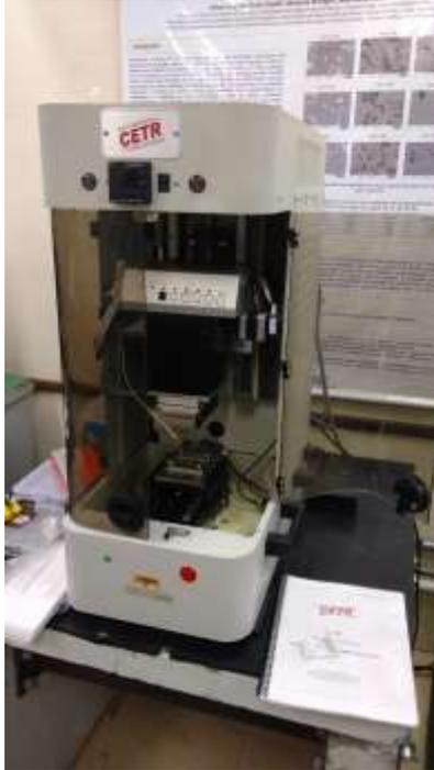
**Figura 28 – Tribômetro para realização de ensaio de riscamento**
