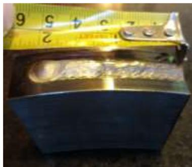
**Figura 26 – Corpo de prova para ensaio de riscamento**
