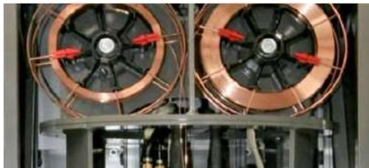
**Figura 22– Sistema de alimentação de duplo arame do modelo FPA9000 ETR**
