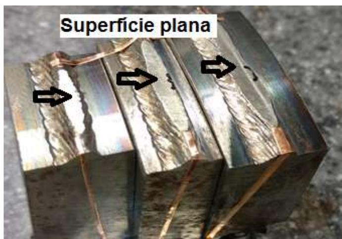
**Figura 27 – Superfície plana nos corpos de prova para ensaio de riscamento**
