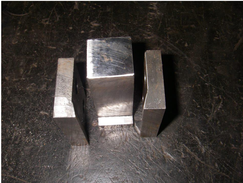
Figura 18- Suporte de corpo de prova aberto fabricado na oficina. Fonte: Autoria própria.
