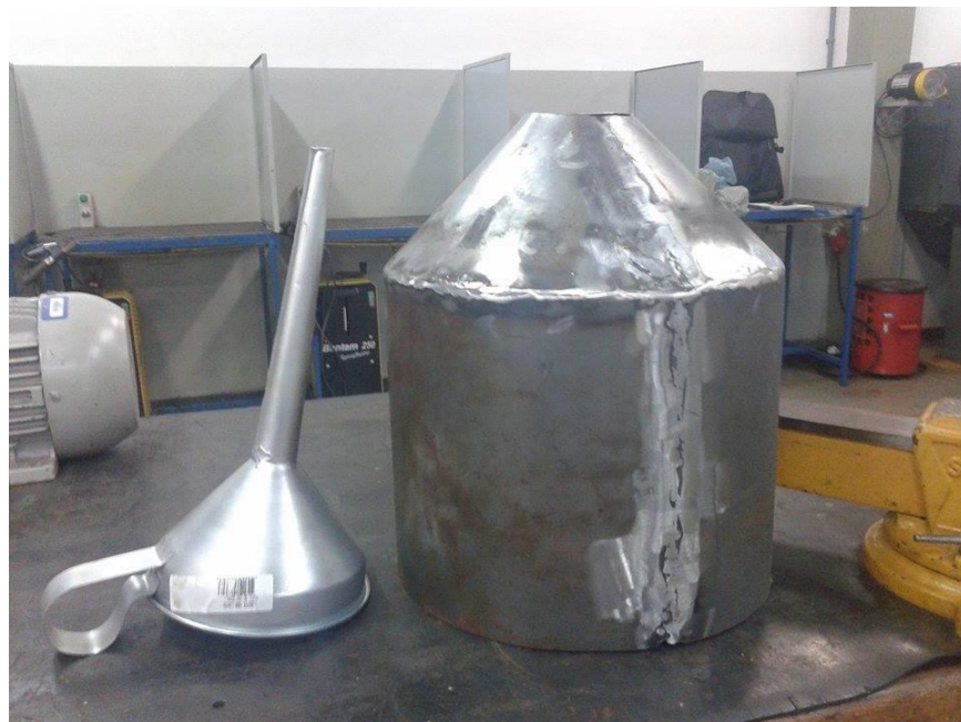
Figura 20- Funil de armazenamento do abrasivo em fabricação. Fonte: Autoria própria.
