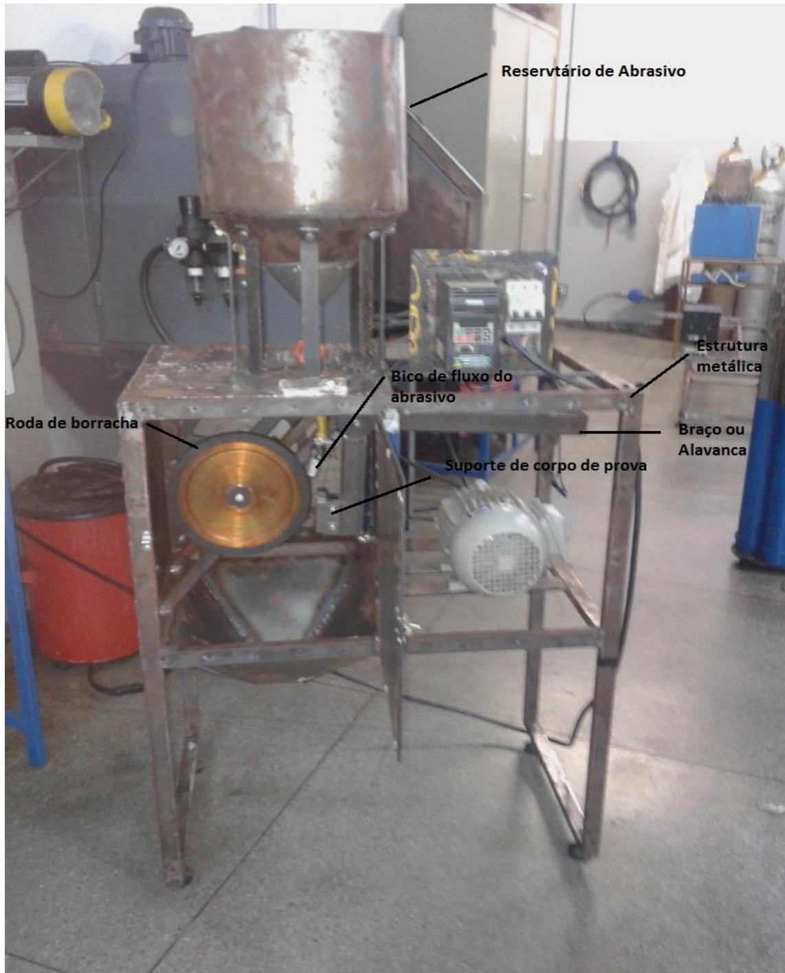
Figura 26- Abrasômetro tipo roda de borracha fabricado na UTFPR-CP Fonte: Autoria própria.
