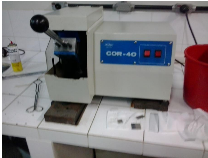
Figura 13 - Cortadora metalográfica AROTEC COR-40, UTFPR-CP. Fonte: FAMBRINI (2013).
