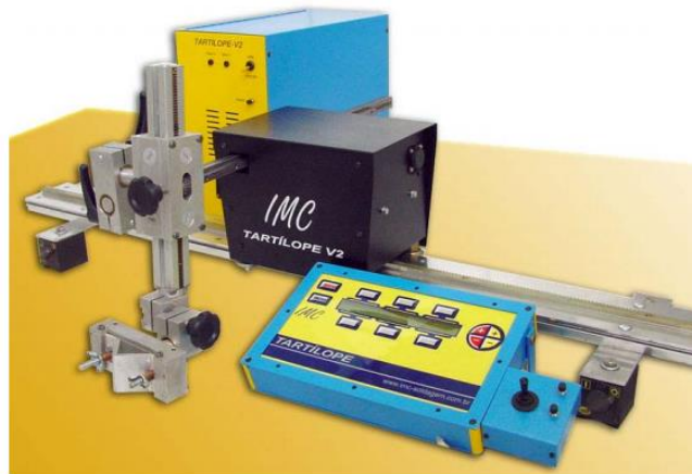
Figura 10 - Foto do dispositivo de avanço automático - Tartilope V2. Fonte: LABSOLDA ( 2014).
