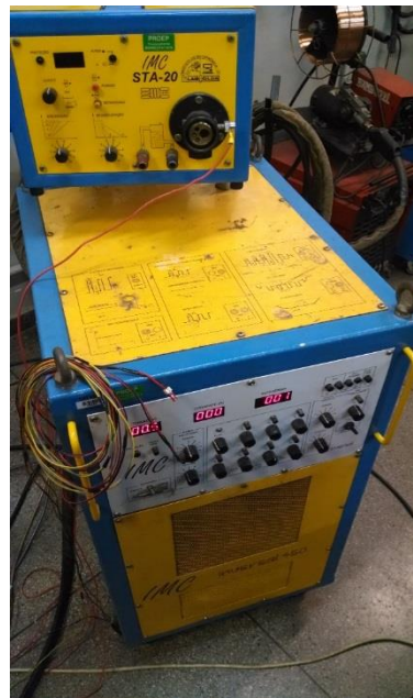
Figura 9 - Foto da central de soldagem utilizada para as deposições, modelo Inversal 450 Fonte: Autoria própria
