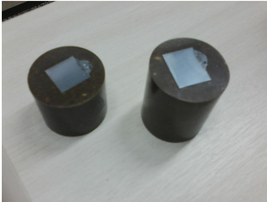
Figura 15 - Corpo de prova embutido sem lixamento e sem polimento. Fonte: Autoria própria.
