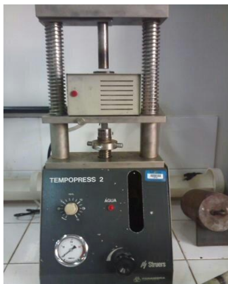
Figura 14 - Embutidora automática Tempopress2, UTFPR-CP. Fonte: FAMBRINI (2013).
